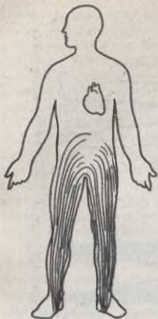
Рис. 6.4. Распределение плотности тока, не прошедшего через область сердечной мышцы и не вызывающего, по мнению Дж. Купфера, смертельного поражения
