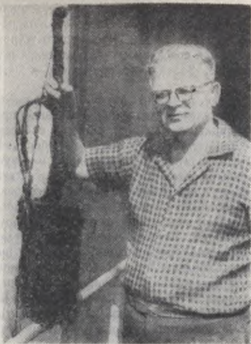
Рис. 11.1. Заземлитель, разъеденный ржавчиной и извлеченный из земли после 20-летней успешной эксплуатации
