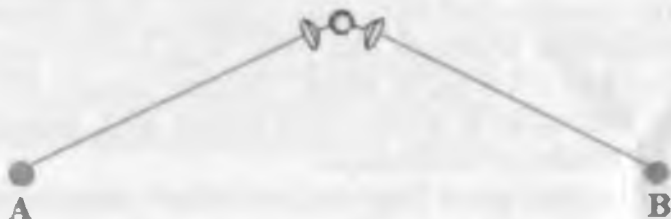
2.14-rasm. Sindiruvchi turidagi passiv retranslyator
