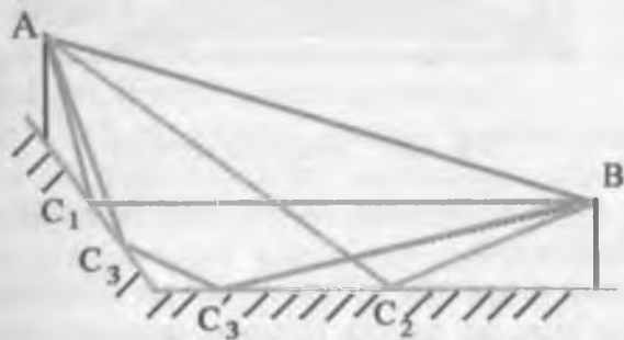
2.3-rasm. Balandlikning qiya tomonida joylashgan antennali trassaning profili
