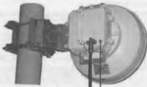
9.2-rasm. Antenna va tashqi blok ODU (bevosita montaj, 1+0 turi) (diapazon 11 – 52 GGts).
