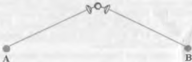
2.14-rasm. Sindiruvchi turidagi passiv retranslyator
