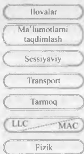
3.25-rasm. Ochiq tizimlar o'zaro bog'lanishining etalon modeli
