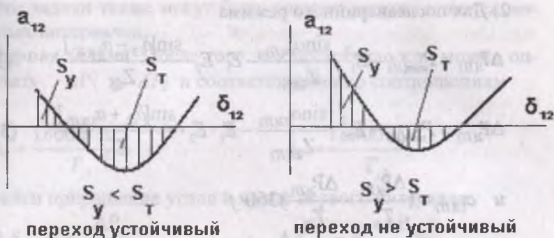
Рис. 3.21. Характеристики относительных ускорений для устойчивого и неустойчивого перехода.
