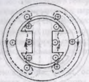
Рис. 1.12. Потокосцепление синхронного генератора по продольной оси при наличии демпферных обмоток (сверхпереходный режим).
