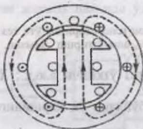
1.10-расм. Синхрон генераторда турғун ҳолатда оқимнинг бўйлама ўқ бўйича ишлаши.
