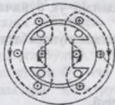
1.11-расм . Синхрон генераторда ўткинчи ҳолатда оқимнинг бўйлама ўқ бўйича ишлаши.
