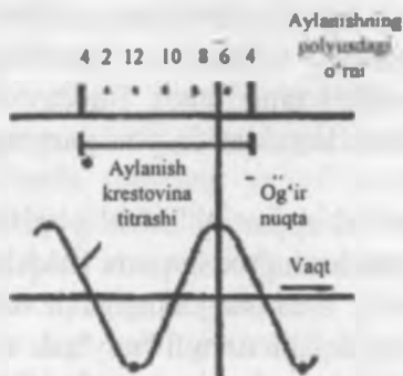
1.10-rasm. Ossillogramma bo'yicha generator rotoridagi mavozanatlilik yukining mahkamlanish joylarini aniqlash. Aylanishlar belgi datchigi va titrash datchiklari bir vertikal tekislikda o'rnatilgan
