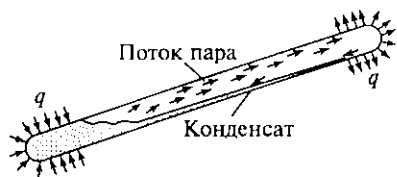
Рис. 4.3. Схема работы тепловой трубы с возвратом конденсата под действием гравитационных сил
