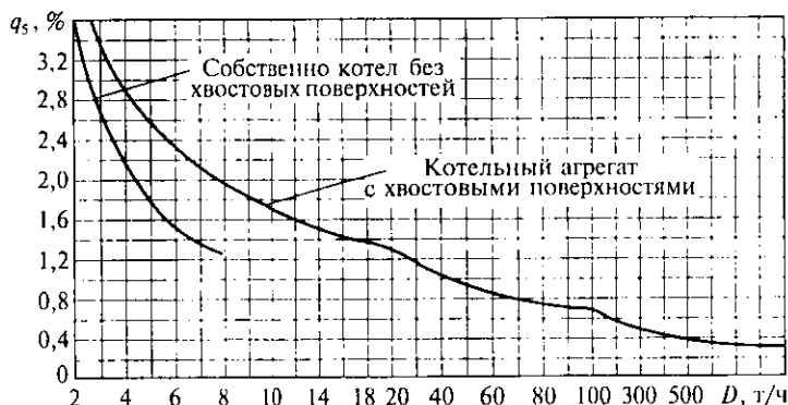
Рис. 6.28. Зависимость потерь теплоты на наружное охлаждение котельного агрегата от его паропроизводительности
