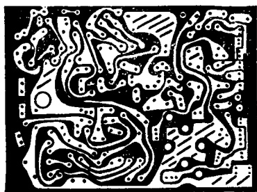
Рис. 6-31. Печатная схема, полученная травлением фольгированного гетинакса
