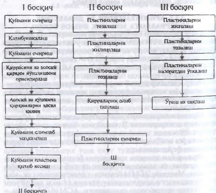
3.6- расм Кремний пластиналарини тайёрлаш умумий маршрутининг схемаси.
