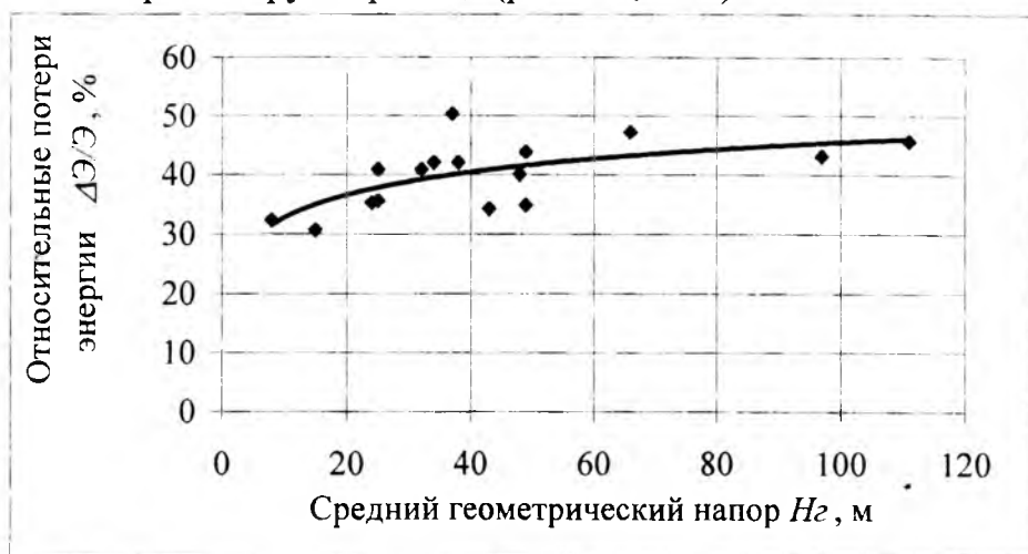
Рис 4.9. Зависимость относительных потерь энергии от среднегеометрического напора насосных станций.
