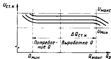
Рис. 9.12. Статические характеристики узла нагрузки со статическим тиристорным компенсатором
