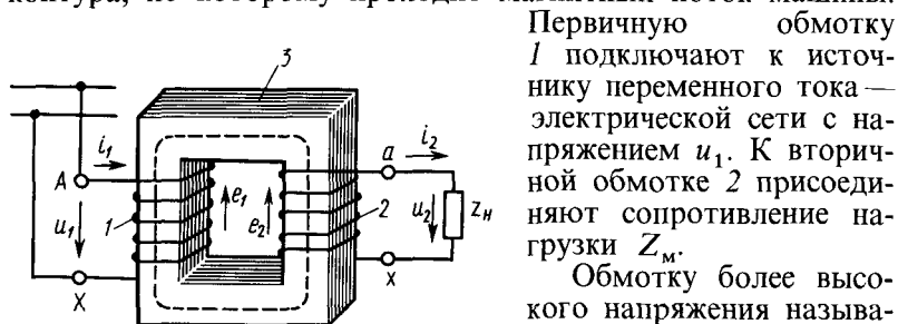
Рис. 2.1. Электромагнитная система однофазного трансформатора: 1, 2 — первичная и вторичная обмотки; 3 — магнитопровод
