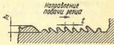
Рис. 8.7. Профиль поверхности вала, подготовленной к напылению:
