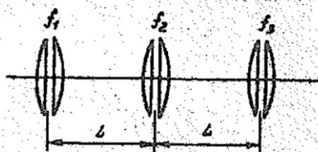
Рис. 4.3. Линзовый волновод, эквивалентный лазерному резонатору.
