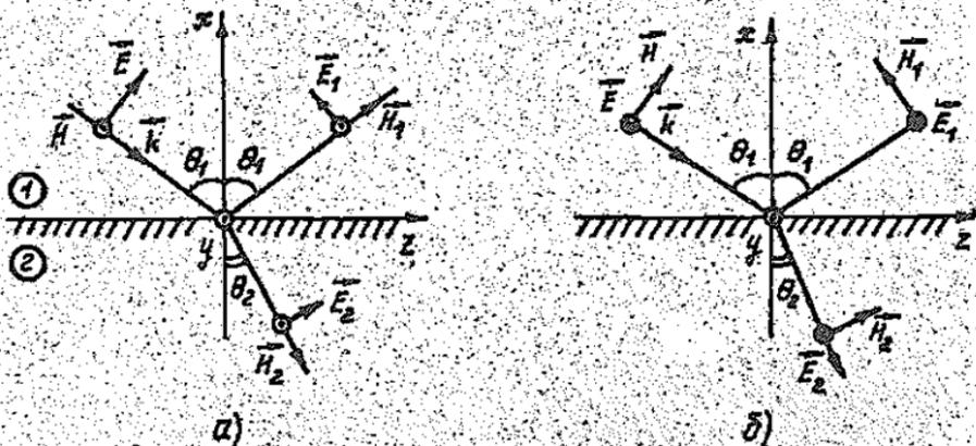
Рис. I.1. Отражение и преломление плоской электромагнитной волны: а —  $E$ -волна ( $p$ -поляризация); б —  $H$ -волна ( $s$ -поляризация).
