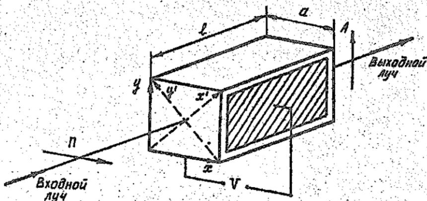
Рис.5.1. Схема электрооптического амплитудного модулятора.
