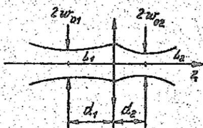
Рис. 4.8. Преобразование гауссова пучка линзой.
