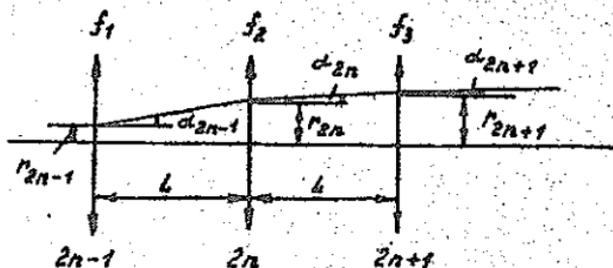
Рис. 4.4. Траектория луча в линзовом волноводе, показанном на рис. 4.3.
