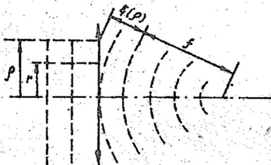
Рис. 3.1. Действие линзы как фазового корректора.
