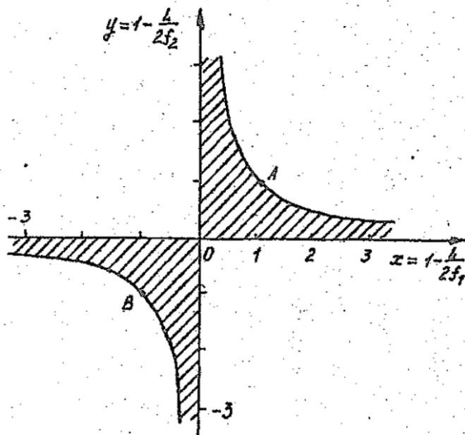
Рис.4.5. Области устойчивости (заштрихованы) лазерного резонатора и линзового волновода.
