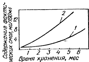
Рис. 23. Осмоление бензина термического крекинга при хранении (по Н. В. Брусянцеву):
