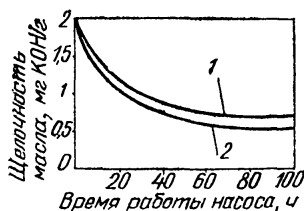
Рис. 61. Зависимость щелочности масла от времени работы при его подаче:
