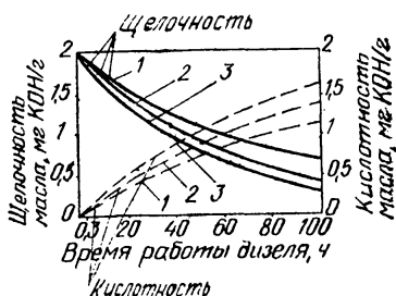
Рис. 65. Зависимость показателей моторного масла в дизеле Д-50 от времени его работы при объеме смазочной системы:
