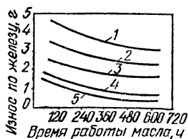
Рис. 85. Зависимость количества снимаемого с деталей железа от времени работы масла для дизелей:
