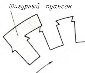
Рис. 12.12. Схема штамповки листа якоря машины постоянного тока с обсеккой наружного диаметра.
