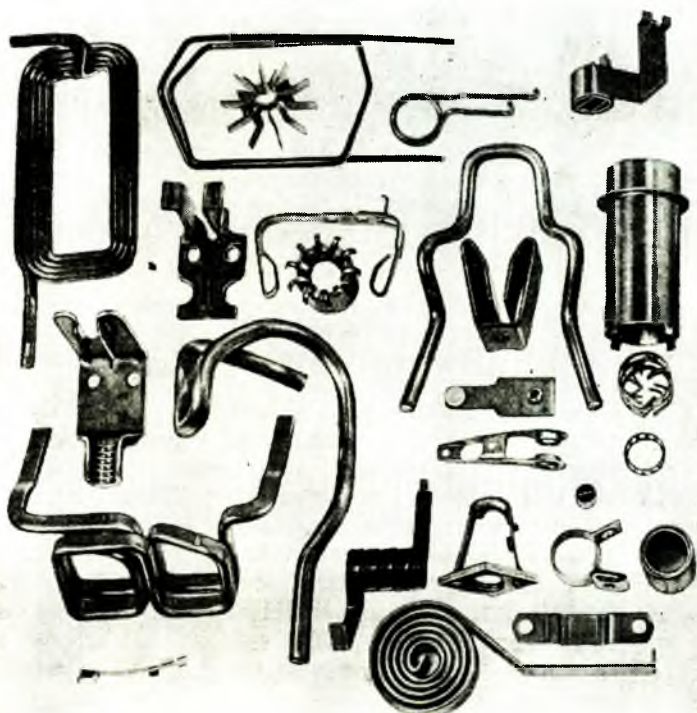
Р и с. 12.27. Автомат холодной штамповки с приводом от центральной шестерни (а) и штампуемые на нем детали (б).
