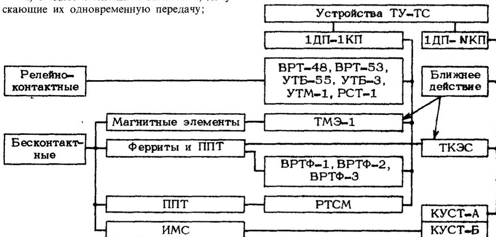
Рис. 17.19. Классификация устройств ТУ – ТС, применяемых в промышленной энергетике
