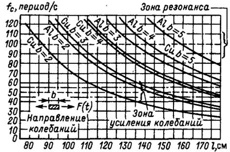
Рис. 22.18. Частотные характеристики медных и алюминиевых шин прямоугольного сечения при расположении шин в одной плоскости узкой стороной друг к другу
