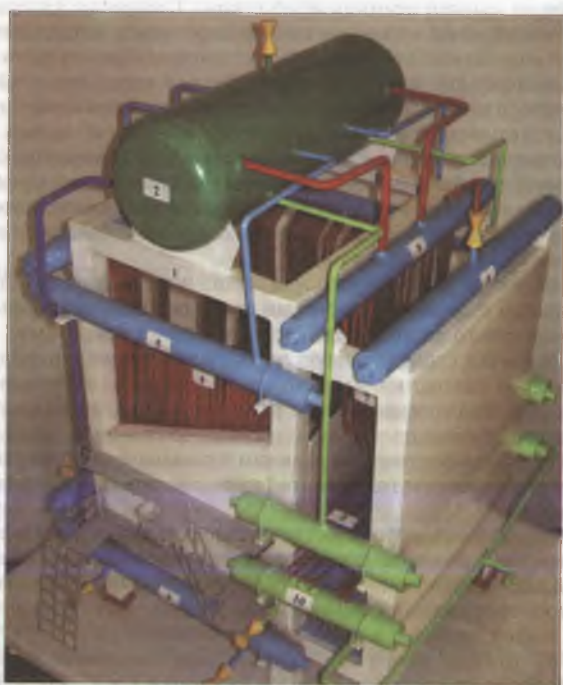
Рис. 3.10. Макет парового котла типа ТГМ-94 паропроизводительностью 500 т/час
