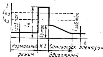
Рис. 5.12. График изменения тока в линии при нормальном режиме, при коротком замыкании и после его отключения
