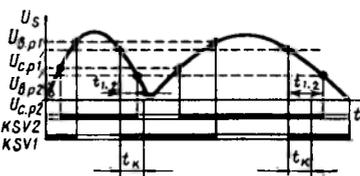
Рис. 10.9. Диаграмма, поясняющая работу органа, контролирующего разность частот напряжений разделившихся частей системы
