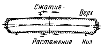
Рис. 5.3. Деформация барабана котла при разных температурах верхней и нижней образующих ( t_{\text{низ}} < t_{\text{верх}} ).
