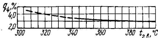
Рис. 2.30. Зависимость потерь тепла с механическим недожогом от температуры горячего воздуха.
