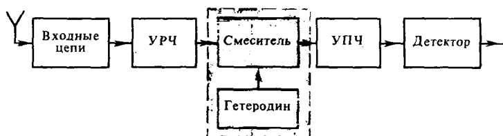
Рис. 12.1. Структурная схема супергетеродинного приемника
