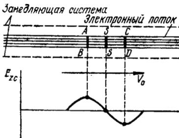
Рис. 8.3. К рассмотрению процесса взаимодействия поля системы с электронным потоком в ЛБВ
