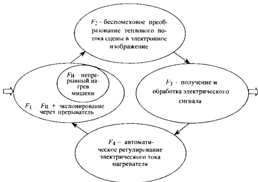
Рис. 2.6. Функциональная схема обликвого решения
