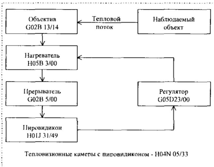
Рис. 2.1. Обобщенная информационно-структурная схема тепловизионных камер с пировидиконом
