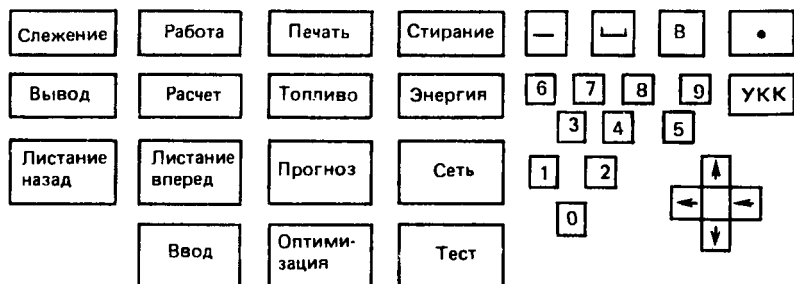
Рис. 3.7. Пример функциональной клавиатуры дисплея в ВК ЭЭС; Топливо, Энергия, Прогноз, Сеть, Тест — условные названия задач; в правой части показано устройство цифрового набора, клавиши сдвига и некоторые служебные клавиши
