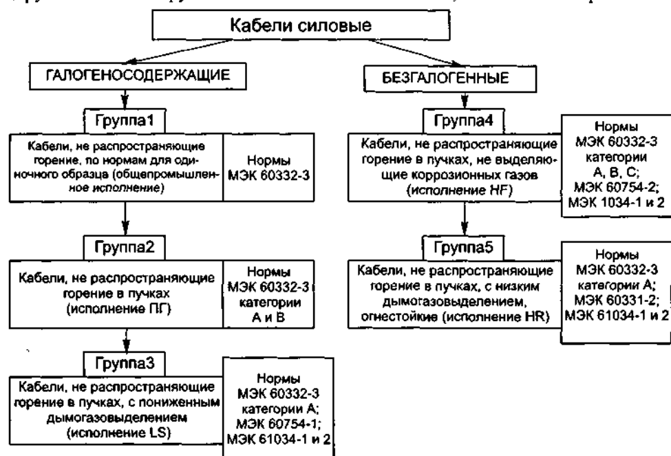
Рис. 13.13. Классификация пожаробезопасных кабелей
