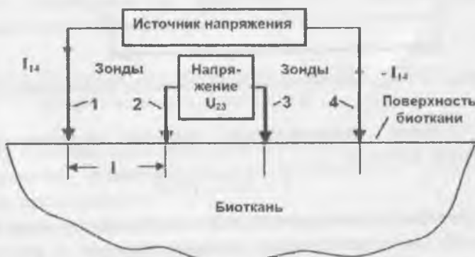
Рис. 3.2. Схема измерений четырехзондовым методом.
