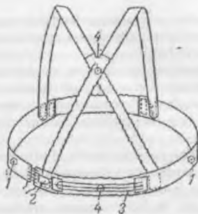
Рис.10.2 Лямочная система фиксации электродов. 1 - электроды D-S, 2 - контактный датчик дыхания; 3 - угольный датчик дыхания; 4 - электроды М-Х.
