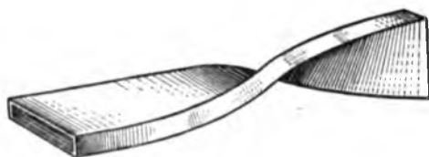
Рис. 1.18. Волноводная труба, скрученная на 90^\circ
