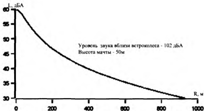
Рис. 5.2. Зависимость уровня шума современной ВЭУ от расстояния от основания башни на уровне земли.
