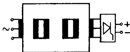
ТРАНСФОРМАТОРНО- ВЕНТИЛЬНЫЕ ПРЕОБРАЗОВАТЕЛИ ЭЛЕКТРОЭНЕРГИИ
