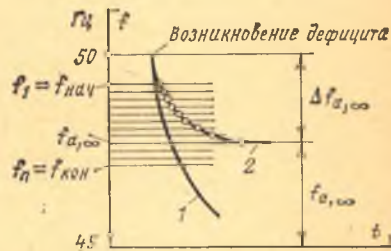
Рис. 5.5. Характер снижения частоты при дефиците активной мощности.
