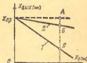
Рис. 6.19. Эффект регулирования по отклонению в статической АСР.
