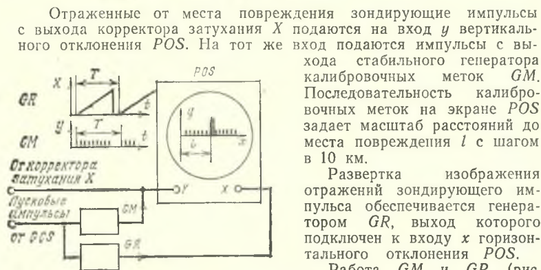
Рис. 12.7. Структура устройства индикации на запоминающей электронно-лучевой трубке.
