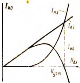
Рис. 1-8. Выходные токи линейного и нелинейного элементов и измерительного органа.
