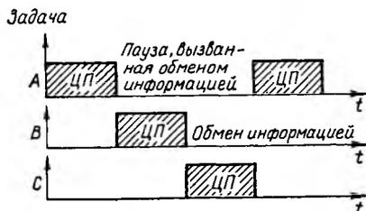
Рис. 2.10. Принцип мультипрограммной обработки задач.
