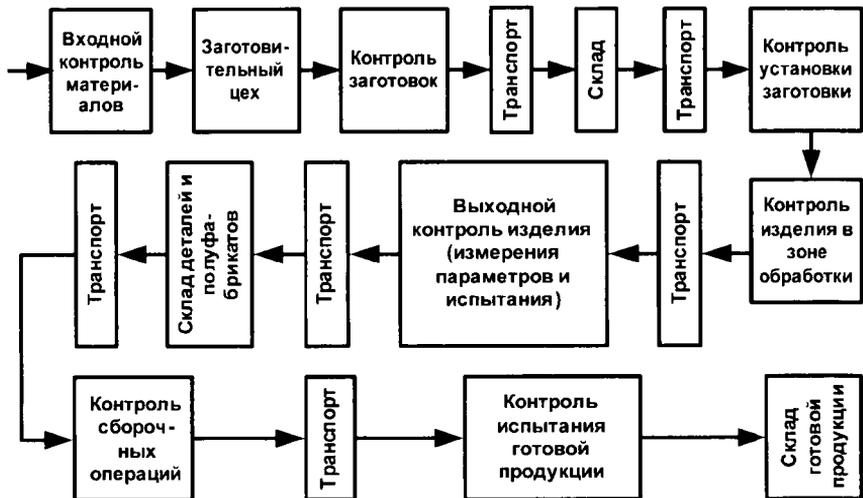
Рис. 6.4. Этапы взаимодействия процесса измерений в его взаимосвязи с основными этапами производства
