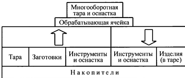
Рис. 3.2. Грузопотоки обрабатывающей ячейки
