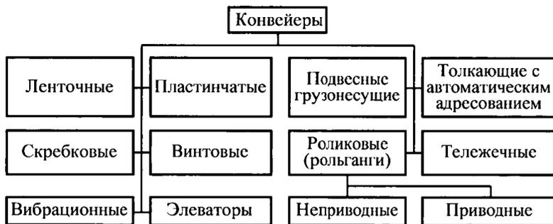
Рис. 3.10. Классификация конвейеров
