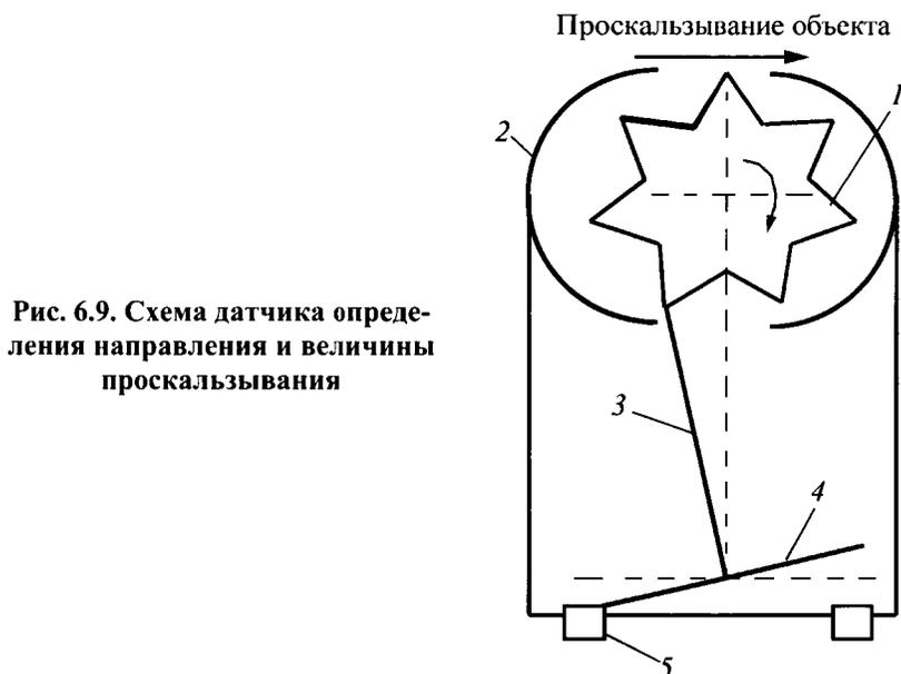
*Тактильные датчики* целесообразно использовать при поиске объектов, идентификации и определении их пространственного расположения, для обнаружения проскальзывания детали и при регулировании усилия захватывания детали (например, в захватном устройстве промышленного робота).
