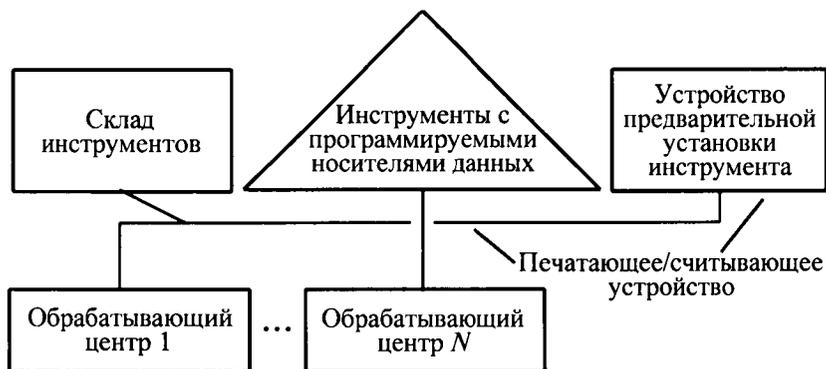
**Рис. 5.12. Передача данных инструмента с помощью носителей данных**
