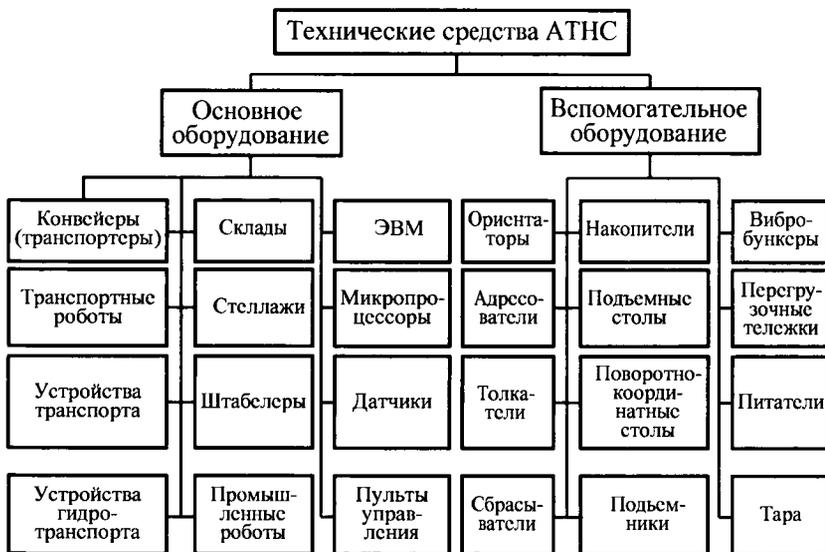
Рис. 3.9. Классификация технических средств АТНС
