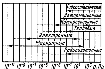
Рис. 6.1. Диапазон рабочих давлений вакуумметров
