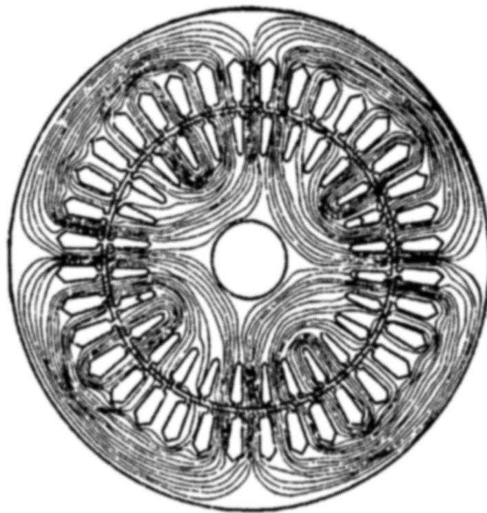
1.34- rasm.Yuklama ostida to'rt qutbli asinxron motorning magnit maydoni.
