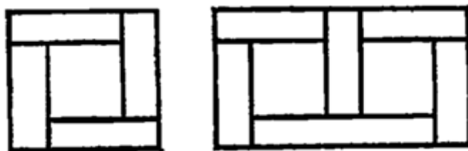
2.37 –rasm. Uchma – uch ulangan magnet o'tkazgichlar: a – bir fazali; b – uch fazali
