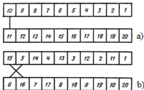
2.29 -rasm. Cho'lg'amdagi uzluksiz va to'qilgan cho'lg'amlar joylashuvi.
