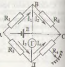
Рис. 8.25. Электрический мост для измерения сопротивлений: G — гальванометр; E — источник тока.
