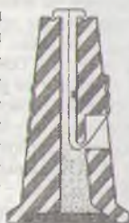
Рис. 13.12. Пробковый предохранитель: 1-плавкая вставка.
