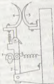
Рис. 13.11. Устройство одного элемента кулачкового контроллера: 1-кулачок; 2-рычаг; 3-колечко; 4-подвижный контакт; 5-неподвижный контакт.
