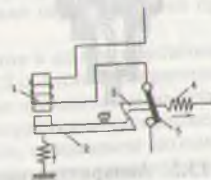
Рис. 13.14. Схема однополюсного воздушного автомата: 1-электромагнит; 2-якорь; 3-крючок; 4-пружина; 5-контакт.
