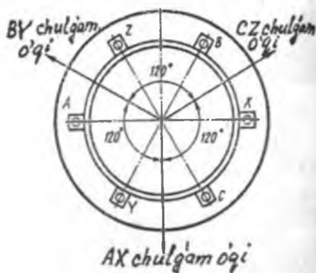
10.19-rasm. Uch fazali ikki qutbli mashina statorida faza chulg'am-larining joylashishi.
