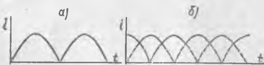
2-4 расм. Ўзгармас ток генераторидан олинган токнинг пульсацияланиши:
