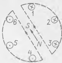
8—11- расм. Статор чулғамида уч фазали токдан ҳосил буладиган айланувчи магнитавий майдон:
