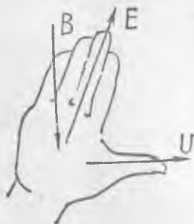
1-2- расм. Ўтказгичда ҳосил бўлган э. ю. к. йўналишини аниқлаш.
