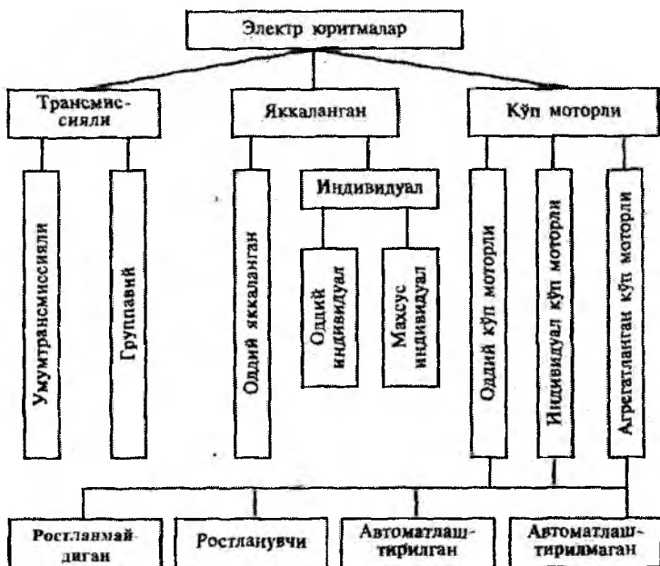
Rasm.6.1. Elektr yuritmalar klassifikatsiyasi sxemasi.
