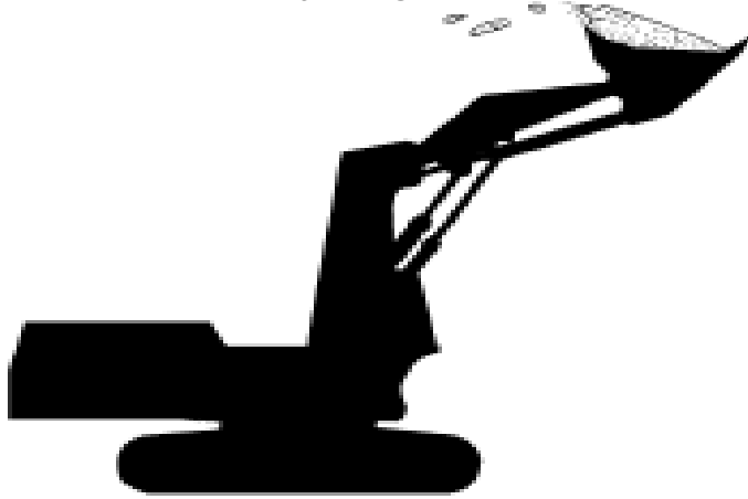
12.8-rasm. Ekskavator yuklayotgan vaqtda oqlar (strela) yuqoriga ko'tarilganda kovshni orqaga qayirishning oqibati
