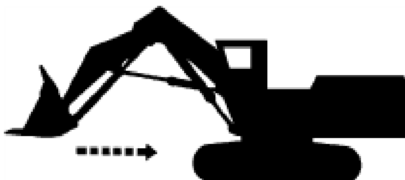
12.3-rasm. Ekskavatorning qazish vaqtida oʻrmalovchi zanjirga (gusenitsaga) kovshning tegib ketishi
