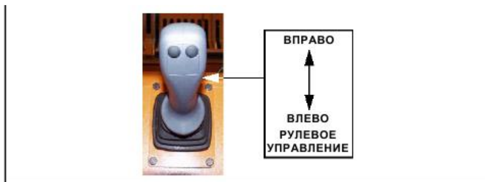
11.6-rasm. Rulni boshqarish –yuk kuzovini boshqarish dastagi. Rulni boshqarish funksiyasi
