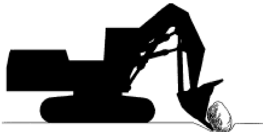
12.4-rasm. Ekskavator yordamida toshlarni surishning oqibatlari
