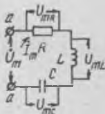
2.31-расм. Кетма-кет тебраниш контури.
