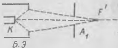
7.34- расм. Бошқарувчи электроднинг бошқарувчи таъсири.
