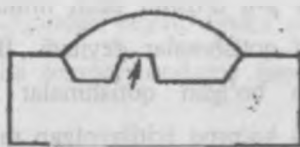
III 19-rasm Yarimo'tkazgich sirtida to'la ho'llanmaslik oqibatida «kallik» hosil bo'lishi
