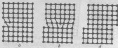
1.10-rasm. Chegaraviy dislokatsiya ko'chish oqibatida kristallning plastik deformatsiyalanishi.
