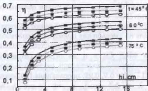
Рис. 9.7. Влияние толщины теплоизоляции дна на КПД «горячего ящика».
