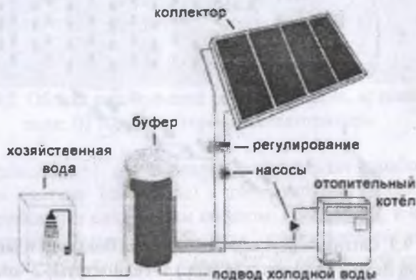
Рис. 9.4. Схема солнечной установки для горячего водо- и теплоснабжения с дублером: солнечный коллектор, системы управления, насосы и бак — аккумулятор (буфер), отопительный котел.
