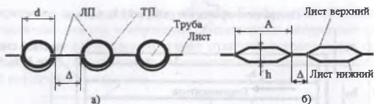
Рис. 9.6. Сечения приемников солнечных коллекторов: листотрубный (а), штампованный (б).
