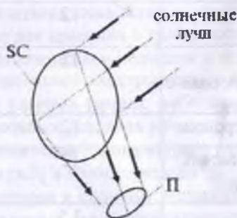
Рис. 8.6. Схема работы концентратора солнечного излучения.
