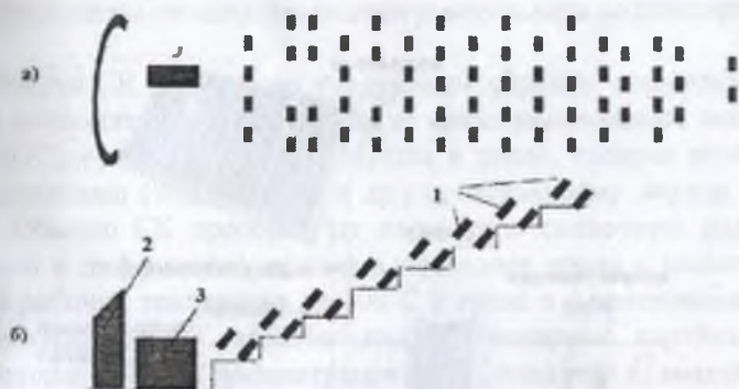
Рис. 9.3. Оптика-энергетическая схема большой плавильной солнечной печи. (Ташкентская обл.) 1—гелиостаты; 2—концентратор; 3—технологическая башня.
