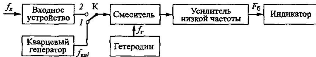
Рис.12.3. Упрощенная структурная схема гетеродинного частотомера
