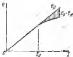
4.9- рasm. Коммутацияловчи секцияда э. ю. к нинг нагрузка токига боғлиқ ҳолда ўзгариш графиги.
