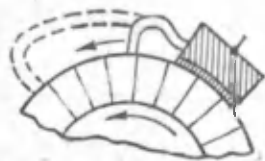
4.13 расм. Коллектор айланганида электр ёйининг чўзилиши.
