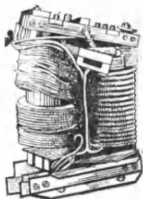
10.14-расм. Қисқа туташувда трансформатор чулғамларининг бузилиши.
