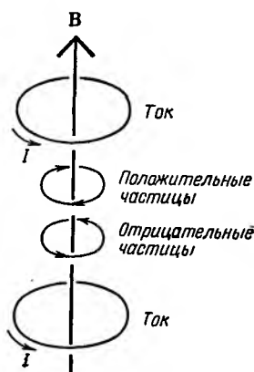
Рис. 2.1. В магнитном поле \mathbf{B} , создаваемом током I , отрицательно заряженные частицы вращаются в направлении тока I , положительно заряженные — в противоположном направлении.
