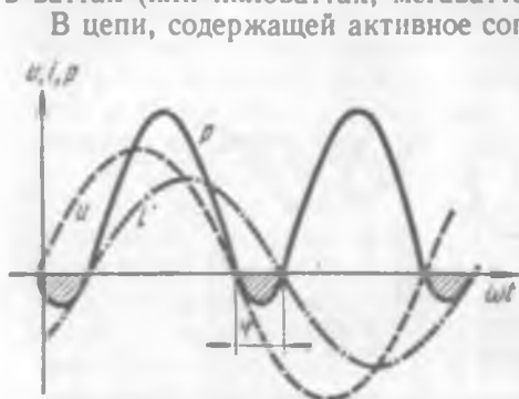
Рис. 57. График мгновенных значений напряжения, тока и мощности
