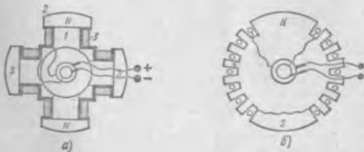
Рис. 111. Ротор синхронной машины: а — с явно выраженными полюсами, б — с неявно выраженными полюсами; 1 — сердечник, 2 — полюсный наконечник, 3 — катушка обмотки возбуждения
