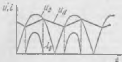
Рис. 176. Кривая выпрямленного напряжения и тока в вентиле при емкостном фильтре
