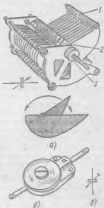
Рис. 7. Конденсаторы переменной (а) и полупеременной (б) емкости и их условные обозначения (в):
