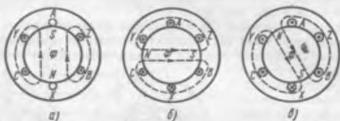
Рис. 70. Магнитное поле трехфазной обмотки в различные моменты времени:
