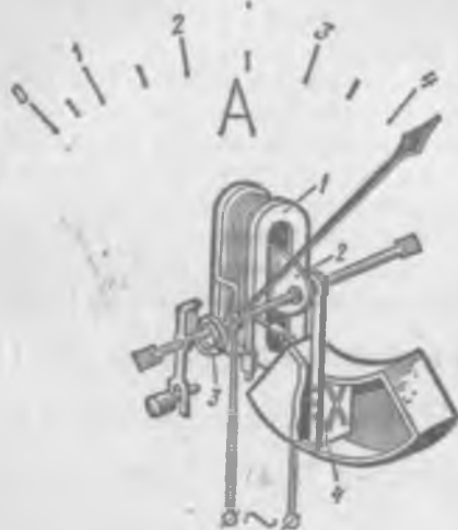
Рис. 77. Устройство электромагнитного прибора с плоской катушкой:
