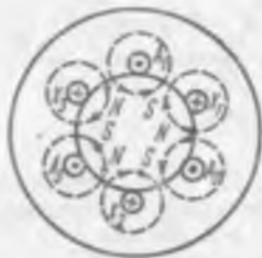
Рис. 73. Схема обмотки статора многополюсной машины
