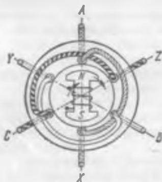
Рис. 58. Схема устройства простейшего трехфазного генератора
