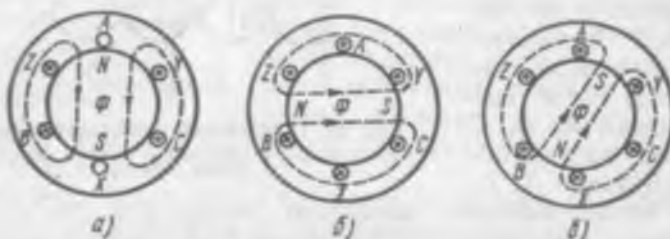
Рис. 71. Магнитное поле трехфазной обмотки в различные моменты времени после изменения чередования фаз:
