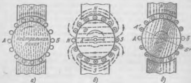
Рис. 121. Магнитное поле машины постоянного тока:
