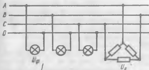
Рис. 65. Схема включения потребителей электроэнергии в четырехпроводную сеть на фазное и линейное напряжения
