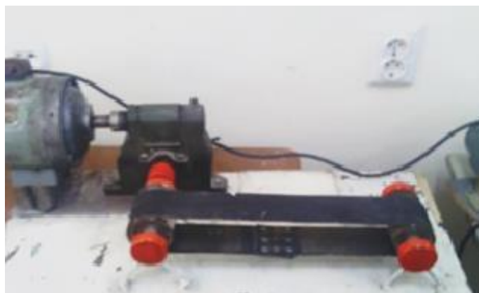
17-rasm. Tasmali konveyerning kinematik sxemasi va maketi 1–elektrodvigatel; 2–mufta; 3–chervyakli reduktor; 4–mufta; 5–konveyer tasmasi; 6–taranglashtirgich.
