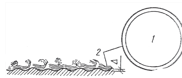
4.4-súwret. Trubadaǵı suıqlıq aǵımınıń turbulent yadrodan (1) hám laminar qatlamshasınan (2) turatuǵın shártli sxemasi.
