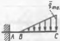
2.3.19. O'lchamlari  $AB=2 \text{ m}$ ,  $BC=6 \text{ m}$  bo'lgan to'sin devorga qistirib mahkamlangan bo'lib, unga intensivliklari  $q_{\max}=30 \text{ N/m}$  va  $q_{\min}=10 \text{ N/m}$  bo'lgan taqsimlangan kuchlar ta'sir etsa,  $A$  tayanchdagi reaktiv momentning miqdorini toping. (660)
