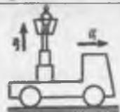
**12.1.4.** Chorpoyali kran  $v_3=0,2 \text{ m/s}$  tezlik bilan harakat qiladi. Uning ustida esa aravacha  $v_2=0,3 \text{ m/s}$  tezlik bilan yurib, I yukni  $v_1=0,4 \text{ m/s}$  tezlikda yuqoriga tortadi. Yukning absolut tezligini toping. (0,539)
