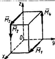
**5.2.4.** Momentlari  $M_1=2$  N·m,  $M_2=1,41$  N·m va  $M_3=2$  N·m bo'lgan uchta juft kuch sistemasi berilgan bo'lib, ularning vektorlari  $Oxy$  tekisligida  $\alpha=60^\circ$ ,  $\beta=45^\circ$  va  $\gamma=30^\circ$  burchaklar orqali aniqlangan, juft kuchlarning teng ta'sir etuvchisi momentining modulini toping. (2,45)
