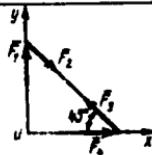
**2.2.21.** Kvadratning uchlariga ta'sir qiluvchi to'rtta  $F_1=F_2=F_3=1\text{N}$  va  $F_4$  kuchlar sistemasining teng ta'sir etuvchisi  $R=2\text{N}$  bo'lsa,  $\bar{F}_4$  kuchning miqdorini aniqlang. (1,0)
