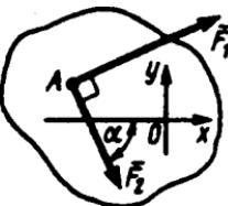
**1.1.8.** Pressning  $O$  nuqtasiga kattaliklari  $F_1=5\text{N}$  va  $F_2=7\text{N}$  ikki kuch ta'sir qiladi. Agar ular bir tekislikda joylashgan va vertikal bilan  $\alpha=30^\circ$  va  $\beta=45^\circ$  burchak tashkil etsa, jismni siquvchi kuchning vertikal tashkil etuvchisining qiymatini aniqlang. (9,28)
