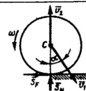
**22.4.4.** Gimnastik halqa burab otilgan bo'lib, yerga tushishdan avval uning massa markazi  $v_1=3\text{m/s}$  tezlikka ega bo'ldi. Zarbadan keyin halqa  $v_2=1,8\text{m/s}$  tezlik bilan yuqoriga sakraydi. Agar tushish va sakrash burchaklari  $\alpha=45^\circ$ ,  $\beta=32^\circ$  bo'lsa, normal impuls  $S_N$  ning tiklash koefitsiyentini toping. (0,720)
