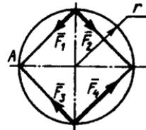
**2.2.16.** Uchta  $F_1=3,46\text{N}$ ,  $F_2=2\text{N}$  va  $F_3=4\text{N}$  kuchlar sistemasi kvadratning uchlariga joylashgan bo'lib, ularning teng ta'sir etuvchisi vertikal yo'nalgan bo'lsa,  $\alpha$  burchakning qiymatini toping. (6,0)
