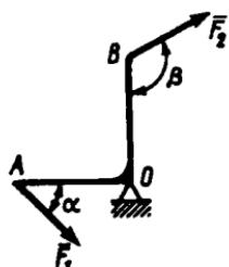
**2.1.12.**  $O$  nuqtasida sharnir yordamida mahkamlangan, bir jinsli  $OA$  sterjenga  $\alpha=45^\circ$  burchak ostida  $\bar{F}$  kuchi ta'sir etadi. Agar sterjenning og'irligi  $5\text{N}$  bo'lib,  $\bar{F}$  kuchi ta'sirida vertikal tekislikda muvozanatda bo'lsa,  $\bar{F}$  kuchining qiymatini aniqlang. (2,5)
