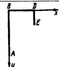
**6.1.4.** Uzunliklari  $l_1$  va  $l_2$  bo'lgan bir jinsli bukilgan sim shaklda ko'rsatilgan holda osib qo'yilgan. Agar  $OK=0,2$   $l_2$  bo'lsa,  $l_2$  qismi gorizontal holda qolishi uchun  $l_1/l_2$  nisbat qancha bo'lishi lozim? (1,5)
