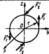
**5.2.10.** Qiymatlari  $F_1=F_1'=1\text{ N}$ ,  $F_2=F_2'=2\text{ N}$  va  $F_3=F_3'=1,5\text{ N}$  bo'lgan juft kuchlarni muvozanatlovchi juft kuchning momentining modulini aniqlang. Bunda  $a=1\text{ m}$ ,  $b=1,2\text{ m}$ . (1,82)
