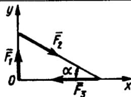
**2.2.9.** Miqdorlari  $10\text{N}$  dan bo'lgan to'rtta kuch sistemasi to'g'ri to'rburchakning uchlari joylashgan bo'lib,  $\alpha=60^\circ$  bo'lsa, shu kuchlar sistemasining bosh vektorining miqdorini toping. (22,4)
