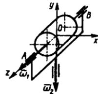
**16.3.15.** Massasi  $m=100 \text{kg}$  bo'lgan g'ildirak  $\omega_1=30 \text{rad/s}$  va  $\omega_2=2,5 \text{rad/s}$  burchak tezliklar bilan tekislik bo'ylab dumalab,  $O$  qo'zg'almas nuqta atrofida aylanadi. Agar g'ildirakning inersiya momenti  $J_{\alpha z}=1,12 \text{kg}\cdot\text{m}^2$  va OC masofa  $1,1 \text{m}$  bo'lsa, giroskopik moment ta'sirida hosil bo'lgan  $N$  tekislik normal reaksiyasini aniqlang. (76,4)
