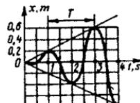
**13.6.18.** Massasi  $m=0,5\text{kg}$  bo'lgan jism bikirlik koeffitsiyenti  $c=200\text{N/m}$  li prujinaga osilgan holda  $F=15\sin pt$  uyg'otuvchi kuch ta'sirida tebransa, rezonans paytida uyg'otuvchi kuchning chastotasi nechaga teng bo'ladi? (20)
