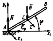
**16.2.14.** Massasi  $m=2\text{kg}$ , uzunligi  $AB=1\text{m}$  bo'lgan bir jinsli sterjen  $\varphi=45^\circ$  tinch holatdan harakatga kelib, uchlari bilan silliq devorga va silliq polga tiralib pastga sirpanadi. Agar  $A$  va  $B$  uchlardagi normal reaksiyalari  $N_A=7,3\text{N}$  va  $N_B=12,2\text{N}$  bo'lsa, sterjenning  $\varepsilon$  burchak tezlanishini aniqlang. (10,4)
