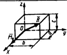
**5.4.12.** Koordinata boshiga nisbatan hisoblangan bosh vektor  $\bar{R}=1\text{N}$  va bosh moment  $M_0=6\text{N}\cdot\text{m}$  berilgan. Agar  $\bar{R}$  Oz bo'ylab,  $\bar{M}_0$  esa Ox va Oy o'qlari bilan  $\alpha=60^\circ$ ,  $\beta=45^\circ$  burchaklarni tashkil etsa, vektorlarning skalar ko'paytmasini aniqlang. (3)
