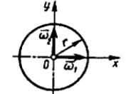
**12.2.8.** Disk 1 bir vaqtning o'zida vertikal va  $\Omega$  o'qlar atrofida  $\omega_1=20\text{rad/s}$  va  $\omega_2=10\text{rad/s}$  burchak tezliklari bilan aylanadi. Disk absolut burchak tezligining miqdorini toping. (25,2)
