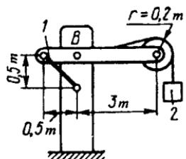
**3.2.29.** Konstruksiyaga osilgan 1 yukning og'irligi  $10 \text{ kN}$  bo'lib, 2 ustun qistirib mahkamlangan  $A$  tayanchdagi moment nolga teng bo'lishi uchun tortib turuvchi  $\bar{F}$  kuchining qiymati  $\text{kN}$  da qancha bo'lishi lozim? Konstruksiyaning boshqa qismlarining og'irliklarini hisobga olmang. (21,4)
