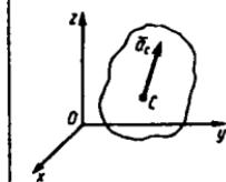
**14.1.6.** Mexanik sistemaning massalar markazi harakati  $\vec{r}_c = 2 \cos \pi \vec{i} + 2 \sin \pi \vec{j}$  radius-vektor orqali aniqlanadi. Agar sistemaning massasi  $M=10\text{kg}$  bo'lsa,  $t=0,5\text{s}$  dagi ta'sir qiluvchi tashqi kuchlar bosh vektorining  $Oy$  o'qidagi proyeksiyasini hisoblang. (-197)
