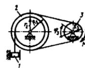
**20.2.14.** Radiusi  $R=0,3\text{m}$  bo'lgan 1 silindrga momenti  $M=120\text{ N}\cdot\text{m}$  li juft kuchi va ishqalanish kuchi momenti  $M_{ishq}=10\text{N}\cdot\text{m}$  ta'sir etib, massasi  $m_2=40\text{kg}$  li 2 yukni yuqoriga tortadi. Silindrnning aylanish burchagi  $\varphi$  ni umumlashgan koordinata sifatida qabul qilib, unga mos umumlashgan kuchni toping. (-7,72)
