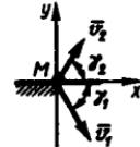
**22.1.3.** Massasi  $m=1\text{kg}$  bo'lgan  $M$  moddiy nuqta  $v_1=10\text{m/s}$  tezlik bilan harakatlanib, tekislikka uriladi. Zarbadan keyingi tezlik  $v_2=8\text{m/s}$  bo'lib, urilish va sapchish burchaklari  $\alpha=60^\circ$  va  $\beta=75^\circ$  bo'lsa, zarbali impulsning  $My$  o'qqa proyeksiyasini aniqlang. (7,07)
