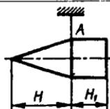
**6.3.12.** Ikkita bir jinsli silindrlardan iborat bo'lgan jism  $A$  nuqtasidan shunday osilganki, simmetriya o'qlari gorizontal holatda joylashgan. Agar silindrning balandligi  $H_1=0,5\text{m}$  va radiusi  $R=3r$  bo'lsa, silindrning  $H$  balandligini aniqlang. (1,5)
