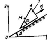
**11.1.4.** 1 jism o'zgarmas  $v_1=2\text{m/s}$  tezlik bilan gorizontal tekislik bo'ylab harakat qiladi. Uning ustida esa 2 jism o'zgarmas  $v_2=4\text{m/s}$  tezlik bilan yuqoriga ko'tarilmoqda. Agar boshlang'ich paytda,  $t=0\text{ s. da}$   $x_2=0$  bo'lsa,  $t=0,5\text{s}$  paytdagi 2 jismning  $x_2$  koordinatasini aniqlang. 2 jism moddiy nuqta deb qaralsin. (2)
