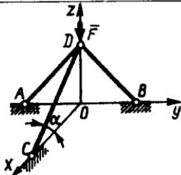
1.4.6. Og'ir yuklarni ko'tarish uchun ishlatalidigan «uch oyoq» uchta  $AC$ ,  $OC$  va  $BC$  sterjenlar hamda dastakli barabandan iborat. Agar 1 yukning og'irligi  $60N$  va burchaklar  $\alpha=60^\circ$ ,  $\beta=45^\circ$  bo'lsa,  $AC$  sterjen zo'riqishini aniqlang.  $DCE$  sim arqon  $Oyz$  tekisligida joylashgan. (-19,1)
