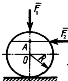
**2.6.4.** Og'irligi  $2 \text{ kN}$  bir jinsli g'ildirakka gorizontal  $\bar{F}$  kuchi ta'sir etib, g'ildirak sirpanmay va dumalamay turishi uchun kuchning eng katta qiymatini toping. Bunda g'ildirakning radiusi  $R=0,6\text{m}$  va o'lchamlari  $OA=0,4\text{m}$ . Sirpanib va dumalab ishqalanish koefitsiyentlarini  $f=0,2$  va  $\delta=0,006 \text{ m}$  deb oling. (12,0)
