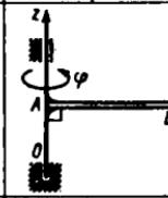
**15.4.5.** Massasi  $m=18\text{kg}$  bo'lgan to'g'ri to'rtburchak shaklidagi plastina  $\omega=4\text{rad/s}$  burchak tezlik bilan  $AB$  o'q atrofida aylansa, plastinaning uzunligini  $b=1\text{m}$  deb, uning kinetik energiyasini aniqlang. (48)
