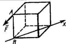
**5.1.7.** O'lchamlari  $a=10\text{m}$ ,  $b=6\text{m}$ ,  $c=20\text{m}$  bo'lgan parallelepipedning A nuqtasiga qo'yilgan  $F=4\text{ kN}$  kuchning  $Oy$  o'qiga nisbatan momentini hisoblang. ( $-8 \cdot 10^4$ )
