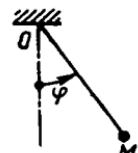
**15.2.5.** 1 jism  $v_1=1\text{m/s}$  tezlik bilan vertikal yuqoriga harakatlanadi. Unga 2 sterjen vositasida massasi  $0,1\text{kg}$  bo'lgan A sharcha mahkamlangan bo'lib, sharcha gorizontall Oy o'qi atrofida  $\omega=10\text{rad/s}$  o'zgarmas burchak tezlik bilan aylanadi. Agar vaznsiz sterjenning uzunligi  $OA=0,2\text{m}$  bo'lsa,  $\varphi=60^\circ$  holat uchun sharchaning kinetik energiyasini hisoblang. (0,35)
