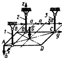
**5.5.9.** Kvadrat shaklidagi  $ABCD$  plitaning og'irligi  $G=115\text{N}$  bo'lib, gorizontal holatda 3 ta vertikal sterjenlar vositasida mahkamlangan. Agar plitaning  $A$  nuqtasiga vertikal  $Q=185\text{N}$  kuch ta'sir qilsa, muvozanat tenglamalarining  $BD$  o'qqa nisbatan olingan momentidan foydalanib, 2 sterjening zo'riqishini aniqlang. (-185)
