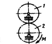
**15.7.5.** Radiusi  $R_2=2R_1$  bo'lgan ikki shkiv tasma yordamida bog'langan bo'lib, tinch holatdan o'zgarmas  $M=2,5\text{ N}\cdot\text{m}$  juft kuch momenti ta'sirida harakatga keladi. Agar shkivlarning aylanish o'qiga nisbatan inersiya momentlari  $J_2=2J_1=1\text{ kg}\cdot\text{m}^2$  bo'lsa, 1 shkiv uch marotaba aylangandan so'ng burchak tezligi nechaga teng bo'ladi? (11,2)
