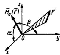
**5.1.4.**  $\bar{F}$  kuchining  $O$  markazga nisbatan momenti miqdori  $M_O(\bar{F}) = 100\text{N}\cdot\text{m}$  bo'lib, vektori esa koordinata o'qlari bilan  $\gamma = 30^\circ$  va  $\varphi = 30^\circ$  burchaklar tashkil qilsa, kuchning  $Oy$  o'qiga nisbatan momentini hisoblang. (25)
