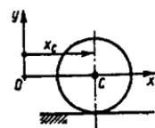
**17.2.18.** Massasi  $10\text{kg}$ , radiusi  $r_1=12\text{sm}$  bo'lgan bir jinsli disk radiusi  $r_2=20\text{sm}$  li silindrik sirtning tashqi tomoni bo'ylab dumalaydi. Agar disk markazi  $O$ ,  $s=50t^2$  ( $\text{sm}$ ) qonun bo'yicha harakat qilsa,  $t=1\text{s}$  paytdagi inersiya kuchlari bosh vektorining qiymatini toping. (32,8)
