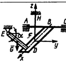
**5.7.6.** Og'irligi  $G=10\text{kN}$  bo'lgan yuk sim arqon vositasida richagli valga osib qo'yilgan. Richagli val esa podshipniklar va  $CC_1$  sim arqon yordamida mahkamlangan. Agar  $Cxy$  tekislik gorizontal,  $O_1O_2O_3$  tekislik esa  $Cyz$  tekislikda joylashgan bo'lsa,  $CC_1$  vertikal sim arqonda hosil bo'layotgan taranglik kuchini toping (kN). (5)
