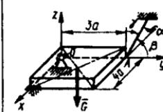
**5.6.11.** Tomonlari  $a=0,2\text{m}$  bo'lgan jism  $G=11\text{kN}$  og'irlikka ega bo'lib,  $F=3\text{kN}$  kuch ta'sirida va shaklda ko'rsatilgan bog'lanishlar yordamida muvozanatda ushlab turiladi.  $AB$  arqonning taranglik kuchini,  $Ox$  o'qiga nisbatan moment tenglamasini tuzib toping. ( $4 \cdot 10^3$ )
