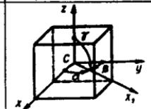
**14.4.22.** Massasi  $m=0,8\text{kg}$ , radiusi  $r=0,1\text{m}$  bo'lgan bir jinsli yupqa diskning  $Oxyz$  o'qlarga nisbatan  $\alpha=30^\circ$ ,  $\beta=60^\circ$ ,  $\gamma=90^\circ$  burchaklar ostida yotuvchi  $Ox_1$  o'qqa nisbatan inersiya momentini toping. (2,5)
