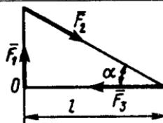
**2.2.8.** Uchta  $F_1=3\text{N}$ ,  $F_2=6\text{N}$ ,  $F_3=14\text{N}$  kuchlar sistemasi to'g'ri burchakli uchburchakning uchlari bo'yicha joylashgan bo'lib, sistemaning bosh vektori  $Ox$  o'qiga parallel bo'lsa,  $\alpha$  burchakning qiymatini toping. (30,0)
