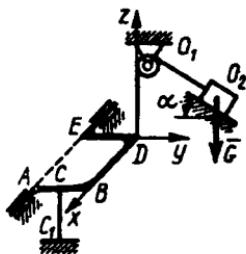
**5.7.8.** Og'irligi  $G=2,5\text{kN}$  bo'lgan yuk sim arqon yordamida richagli valga osib qo'yilgan. Richagli val esa podshipniklar va  $O_1O_2O_3$  sim arqon vositasida mahkamlangan. Agar  $ABCD$  gorizontal holatda,  $O_1O_2O_3$  tekislik  $Byz$  tekislikka parallel va  $DO_1=O_1C$  bo'lsa,  $O_2$  sharnirda hosil bo'lgan reaksiya kuchini aniqlang (kN). (17,3)
