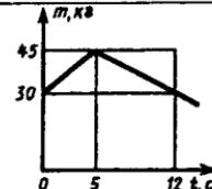
**23.1.5.** Idish suv nasosi yordamida suyuqlik bilan to'ldirilmoqda. Uning massasi o'zgarishi shakldagidek bo'lsa, reaktiv kuchning modulini aniqlang. Suyuqlik zarralarining qo'shilishdagi nisbiy tezligi  $2,8\text{m/s}$  ga teng. (6,44)
