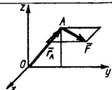
**5.1.3.**  $F$  kuchining  $O$  markazga nisbatan momenti  $M_O(\bar{F}) = 10\text{N}\cdot\text{m}$  miqdorga teng bo'lib, vektori esa  $Ox$  va  $Oy$  koordinata o'qlari bilan  $\alpha = 120^\circ$  va  $\beta = 120^\circ$  burchaklar tashkil qilsa, kuchning  $Ox$  o'qiga nisbatan momenti qanchaga teng bo'ladi? (-5)
