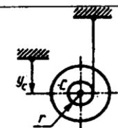
9.3.5. Radiusi  $R=0,1\text{m}$  bo'lgan baraban  $\varphi=0,3t^2$  qonun bo'yicha aylanib, radiusi  $r=0,06\text{m}$  li 2 blokni tortadi. Blokning burchak tezlanishini aniqlang. (0,5)
