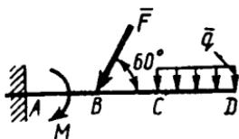
**2.4.35.** O'lchamlari  $AB=BC=2\text{m}$  bo'lgan, qistirib mahkamlangan to'singa  $F_1=50\text{N}$  va  $F_2=100\text{N}$  kuchlar ta'sir qilayotgan bo'lsa,  $A$  tayanchdagi reaksiya momentini toping. (446)
