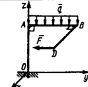
**5.4.6.** O'lchamlari  $AB=3\text{m}$ ,  $AB \parallel Ox$ ,  $BD \perp AB$ ,  $BD \parallel Oy$  bo'lgan bukilgan to'singa miqdorlari  $F=10\text{N}$  kuch va intensivligi  $q_{\max}=20\text{N/m}$  li taqsimlangan kuchlar ta'sir etadi. Kuchlar sistemasining bosh vektorining miqdorini aniqlang. (20)
