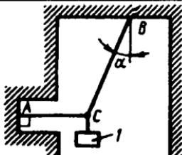
**1.2.7.** Og'ir yuk vaznsiz ikki sterjen yordamida yerga mahkamlangan. Agar  $AC$  sterjen yerga nisbatan  $\alpha=60^\circ$ ,  $BC$  esa  $\beta=30^\circ$  burchak tashkil qilib,  $AC$  sterjenning zo'riqishi  $43\text{N}$  bo'lsa,  $BC$  sterjendagi reaksiya kuchini aniqlang. (-24,8)
