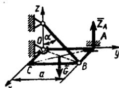
**5.6.8.** O'lchamlari  $a=0,1\text{m}$  bo'lgan bir jinsli jismning og'irligi  $G=60\text{N}$  bo'lib, shaklda ko'rsatilgan bog'lanishlar vositasida muvozanatda ushlab turiladi. Kuchlarning  $Ox$  o'qiga nisbatan momenti tenglamalarini tuzib,  $B$  sharnir reaksiya kuchining vertikal tashkil etuvchisini toping. (40)
