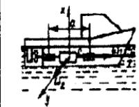
**16.3.17.** Inersiya momenti  $J_{\alpha z}=0,5 \text{kg}\cdot\text{m}^2$ , podshipniklari orasi  $a=0,5 \text{m}$  bo'lgan qayiqning motori o'z o'qi atrofida  $\omega_1=151 \text{rad/s}$ , ko'ndalang to'lqin ta'sirida esa  $\omega_2=0,5 \text{rad/s}$  burchak tezliklar bilan aylansa, podshipniklarga tushadigan giroskopik bosimni toping. Bu yerda  $\bar{\omega}_1, \bar{\omega}_2$  ga perpendikular. (75,5)
