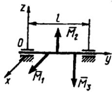
**5.2.18.** Bir jinsli  $ABCD$  kvadrat platforma ikkita vertikal sterjenlar yordamida gorizontal holatda mahkamlangan bo'lib, unga momentlari  $M_1=3,2\text{N}\cdot\text{m}$ ;  $M_2=2,5\text{N}\cdot\text{m}$  va  $M_3$  bo'lgan juft kuchlar ta'sir etadi. Agar platforma muvozanat holatida bo'lsa,  $M_3$  ning qiymatini toping (Moment vektorlarning  $AC$  o'qqa proyeksiyalari yig'indisi orqali aniqlash qulayroq). (4,03)
