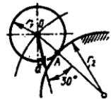
**17.2.20.** Krivoship l  $\omega = 4 \text{ rad/s}$  o'zgarmas burchak tezlik bilan aylanib, massasi  $m=4\text{kg}$  va radiusi  $r=15\text{sm}$  bo'lgan bir jinsli 2 g'ildirakni harakatga keltiradi. Agar g'ildirak radiusi  $R=40\text{sm}$  li silindrning ichki devori bo'ylab dumalasa, g'ildirak inersiya kuchlari bosh vektorining modulini aniqlang. (16)
