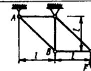
4.2.14. Vertikal va gorizontal sterjenlari o'zaro teng bo'lgan fermaga  $F=600\text{N}$  kuch ta'sir etsa,  $AB$  sterjendagi zo'riqishni aniqlang. (-300)
