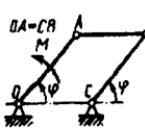
**20.5.3.** Mexanik sistemaning kinetik energiyasi  $T=5\dot{\phi}^2+30\sin\phi \cdot \dot{\phi}$ , umumlashgan kuchi  $Q_\phi=-20\sin\phi$  ga teng. Bunda umumlashgan kuch  $Q$  N·m da, umumlashgan koordinata  $\phi$ - rad da o'lchanadi. Mexanik sistemaning umumlashgan koordinatasi  $\phi=3\text{rad}$  bo'lgan paytdagi burchak  $\phi''$  tezlanishni aniqlang. (0,282)
