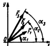
**1.1.5.** Agar  $O$  nuqtaga ikkita  $F_1=2\text{N}$  va  $F_2=4\text{N}$  kesishuvchi kuchlar  $Ox$  o'qiga nisbatan mos ravishda  $\alpha=30^\circ$  va  $\beta=60^\circ$  burchak ostida qo'yilgan bo'lib, uchinchi  $F_3$  kuchining qanday qiymatida uchala kuchning teng ta'sir etuvchisi nolga teng bo'ladi? (6,62)
