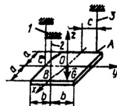
**5.5.14.** Og'irligi  $G=40$  kN, bir jinsli yarim silindr shaklidagi obolochka (yupqa qobiq)  $A$ ,  $B$  va  $C$  nuqtalaridan vertikal po'lat arqonlar yordamida mahkamlangan. Agar 3 arqonning zo'riqishi  $20$  kN bo'lsa, 1 arqondagi reaksiya kuchini kN da toping. (10)
