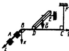
**5.7.4.** Og'irligi  $G=800 \text{ N}$  li yuk gorizontal  $DE$  to'singa o'matilgan.  $DE$  to'sin esa gorizontal joylashgan vertikal  $FH$  sim arqon yordamida osib qo'yilgan  $ABCD$  konstruksiyaga erkin tiraligan. Agar masofalar  $DF=2FB$  va  $AB=BC$  bo'lsa, A podshipnikning reaksiya kuchini aniqlang. (400)
