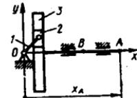
**8.1.6.** Harakatlarni yozib boruvchi uskunaning 1 peroси  $Oxy$  o'qiga parallel bo'lgan S tekislikda siljiydi. Uni harakatga keltiruvchi B qo'zg'aluvchan o'qning ilgarilanma harakat qonuni  $x_B=0,1(1-e^{-0,1t})$ ,  $y_B=0$ ;  $z_B=0$  bo'lsa,  $t=20s$  da A pero nuqtasining tezligini toping. Bu paytda masofalar:  $x_A=x_B$ ,  $y_A=0,2m$ ;  $z_A=-0,1m$ . ( $1,35 \cdot 10^{-3}$ )
