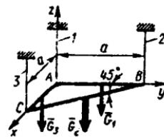
**5.5.12.** O'lchamlari  $a=0,4\text{m}$  va  $EF=AD$  bo'lgan, og'irliliklari  $G_1=10\text{N}$  va  $G_2=8\text{N}$  li ikki plastinalar sharnirlar yordamida bir-biriga hamda sterjenlar vositasida tayanchlarga mahkamlangan. Agar  $ABCD$  gorizontol tekislikda,  $ADEF$  vertikal tekislikda joylashgan bo'lsa, 1 sterjendagi reaksiya kuchini toping. (-4)
