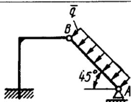
**3.2.27.** Og'irligi 80 N bo'lgan, bir jinsli AB sterjening uchiga B sharnir orqali vazni 200 N li disk o'rnatilgan. Disk silliq vertikal devorga tiral-gan. Diskning devorga ko'rsatgan bosim kuchini aniqlang. (240)
