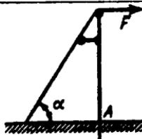
**2.4.45.** Yerga qistirib mahkamlangan to'singa  $h=3\text{m}$  balandlikda sim arqon yordamida  $F=40\text{kN}$  kuch  $\alpha=30^\circ$  burchak ostida ta'sir qilsa,  $A$  tayanchdagi reaksiya momentini kN·m da aniqlang. (120)
