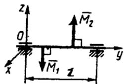
**5.2.16.** Shesternya vali flanesiga (markaziga) momentlari  $M_1=4\text{N}\cdot\text{m}$  va  $M_2=5\text{N}\cdot\text{m}$  bo'lgan juft kuchlar ta'sir etadi. Agar podshipniklar orasi  $\ell=0,1\text{m}$  va  $\bar{M}_1 \parallel Ox$ ,  $\bar{M}_2 \parallel Oz$  bo'lsa,  $O$  podshipnikdagi reaksiya kuchining modulini aniqlang. (64,0)
