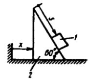
**20.6.19.** Massalari  $m_1=5\text{kg}$  va  $m_2=8\text{kg}$  bo'lgan jismlar  $\bar{F}_1$  va  $\bar{F}_2$  kuchlar ta'sirida harakat qilsa, umumlashgan koordinatalarni  $s_1$  va  $s_2$ , umumlashgan kuchlarini  $Q_{s1}=3\text{N}$   $Q_{s2}=5\text{N}$  deb, 2 jismning tezlanishi  $\ddot{s}_2$  ni aniqlang. (0,625)
