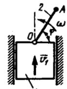
**15.2.6.** Gorizontal platforma vertikal o'q atrofida  $\omega=2\text{rad/s}$  burchak tezlik bilan aylanadi. Aylanish o'qidan  $R=1\text{m}$  masofada massasi  $m=0,2\text{kg}$  nisbiy tezligi  $v_r=3\text{m/s}$  bo'lgan moddiy nuqta aylana bo'ylab harakat qilsa, nuqtaning kinetik energiyasini toping. (2,5)
