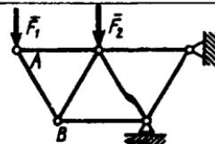
**4.2.4.** O'lchami  $\ell=0,4\text{m}$  sterjenli fermaga  $F=30\text{N}$  kuch ta'sir etadi.  $AB$  sterjendagi zo'riqishni aniqlang. (-21,2)
