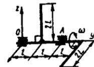
**17.4.12.** Massasi 6kg, o'lchamlari  $l=0,2\text{m}$  bo'lgan to'rtburchak shaklidagi bir jinsli plastina juft kuch momenti  $M$  ta'sirida simmetriya o'qiga perpendikular o'q atrofida  $\phi=5t^3$  qonun bo'yicha aylansa,  $t=1\text{s}$  paytdagi  $A$  podshipnikning dinamik reaksiyasini hisoblang. (68,1)
