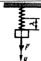
**13.6.5.** Massasi  $m=3\text{kg}$  bo'lган, yuk prujinaga osilgan. Unga  $F=10\sin 5t$  vertikal uyg'otuvchi kuch ta'sir etadi. Agar dinamiklik koeffitsiyenti  $\eta=4$  bo'lsa, prujinaning bikrlik koeffitsiyenti  $c$  ni aniqlang. (100)
