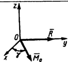
**5.4.11.** Kuchlar sistemasining bosh vektori  $R=1N$  va bosh momenti  $M_0=1N\cdot m$  o'lchamlari  $a=5m$ ,  $b=4m$ ,  $c=3m$  bo'lgan parallelepiped diagonali va  $Ox$  o'qini bo'ylab yo'nalgan bo'lsa,  $\bar{R}$  va  $\bar{M}_0$  vektorlarning skalar ko'paytmasini hisoblang. (0,707)
