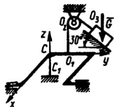
**5.7.7.** Og'ir yuk sim arqon vositasida richagli valga osib qo'yilgan. Richagli val esa podshipniklar va  $CC_1$  sim arqon yordamida mahkamlangan. Agar  $\alpha=30^\circ$  va  $CC_1$  vertikal sim arqonnинг tarangligi  $20\text{kN}$  bo'lsa,  $AC=BC$  deb olib, yukning og'irligini toping (kN). Bunda  $ABDE$  tekislik gorizontal,  $DO_1O_2$  esa vertikal deb oling. (20)
