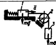
**17.3.15.** Massasi  $m_2=5\text{kg}$  bo'lgan 2 yuk og'irlik kuchi ta'sirida  $a=3\text{m/s}^2$  tezlanish bilan pastga tushib, massasi  $m_1=10\text{kg}$  li bloknini aylantiradi. Agar aylanish o'qi blokning massa markazida bo'lsa, O sharnirda hosil bo'lgan reaksiya kuchining modulini aniqlang. (1,32)
