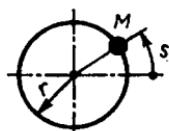
**13.1.20.** Massasi  $m=18\text{kg}$  bo'lgan moddiy nuqta radiusi  $R=8\text{m}$  aylana bo'ylab  $s=e^{0,3t}$  qonun bo'yicha harakat qiladi.  $t=10\text{s}$  da nuqtaga ta'sir qiluvchi kuchlarning teng ta'sir etuvchisining urinma tashkil etuvchisi nimaga teng? (32,5)
