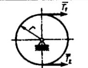
**16.1.12.** Massasi  $4\text{kg}$ , radiusi  $R=0,6\text{m}$  bo'lgan bir jinsli yupqa disk  $Az$  vertikal o'q atrofida  $M_z=1,8\text{N m}$  moment ta'sirida aylansa, diskning burchak tezlanishini aniqlang. (5)
