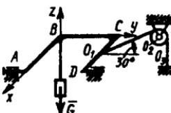
**5.7.9.** Uchiga 1 disk o'rmatilgan 2 gorizontal val  $BC||Ax$  dastakka ega bo'lib, 4, 5, 6 iplar vositasida muvozanatda ushlab turiladi. Agar 1 diskka vertikal  $Q=100\text{N}$  kuch ta'sir etsa va o'lchamlari  $R=2BC$ ,  $\beta=2\alpha=60^\circ$  bo'lsa, 5 ipning taranglik kuchini toping. 4, 5, 6 iplar sistemasi vertikal tekislikda joylashgan. (173)
