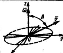
**12.4.3.** Qutb nuqta tezlik vektori  $\bar{v}_0$  va burchak tezlik vektori  $\bar{\omega}$  orasidagi burchak  $30^\circ$  ni tashkil etadi. Agar  $v_0=6\text{m/s}$  va  $\omega=6\text{rad/s}$  bo'lsa, o'qdan kinematik vint o'qigacha bo'lgan masofani toping. (0,5)
