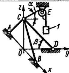
**1.4.3.** Uchta sterjen  $AC$ ,  $BC$  va  $DC$  sharnirlar yordamida mahkamlangan bo'lib,  $C$  sharnirda ularga  $Oyz$  tekisligida joylashgan  $F$  kuchi ta'sir qiladi. Agar  $F=50\text{N}$  va  $\alpha=60^\circ$  berilgan bo'lsa,  $DC$  sterjenning zo'riqishini aniqlang. (-86,6)
