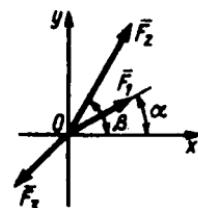
**1.1.6.** Ikkita  $\bar{F}_1$  va  $\bar{F}_2$  kesishuvchi kuchlarining teng ta'sir etuvchisi  $R=10\text{N}$ , shuningdek  $F_1=5\text{N}$  bo'lib,  $\bar{F}_1$  va  $\bar{R}$   $Ox$  o'qi bilan tashkil qilgan burchaklari mos ravishda  $\alpha=60^\circ$  va  $\gamma=30^\circ$  bo'lsa,  $\bar{F}_2$  kuchning modulini aniqlang. (6,64)
