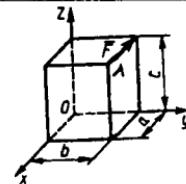
**5.1.8.** Agar  $F=20\text{ N}$  kuch  $Ox$  va  $Oy$  o'qlarini  $a=2\text{m}$  va  $b=3\text{m}$  masofalarda kesib o'tsa, kuchning  $Ox$  o'qqa nisbatan momentini toping. (0)
