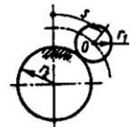
**17.2.19.** Massasi  $20\text{kg}$ , radiusi  $r_1=0,24\text{m}$  bo'lgan bir jinsli silindr radiusi  $r_2$  li doiraviy sirtda dumalaydi. Agar silindr markazi  $O$  ning tezlanishi  $a=60\text{m/s}^2$  bo'lsa, silindr inersiya kuchlarining bosh momentini hisoblang.  $A$  nuqtani keltirish markazi deb olinsin. (-216)
