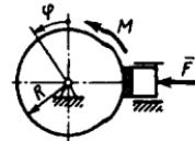
**20.2.5.** Radiusi  $R=0,25\text{m}$  bo'lgan silindr momenti  $M=25\text{ N}\cdot\text{m}$  juft kuch ta'sirida aylanib, massasi  $m=30\text{kg}$  li 1 jismni cho'zilmaydigan ip yordamida tortadi. Agar 1 jism va gorizontal tekislik orasidagi ishqalanish koefitsiyenti  $f=0,2$  bo'lsa,  $x$  umumlashgan koordinataga tegishli bo'lgan umumlashgan kuchni aniqlang. (41,1)
