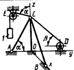
1.4.7. Og'irligi  $G=100N$  bo'lgan bir jinsli plita uchta sim arqonlar yordamida  $Oyz$  tekisligida muvozanatda ushlab turilibdi. Agar  $CD$  sim arqon  $Oyz$  tekisligida bo'lib, burchak  $\alpha=30^\circ$  bo'lsa,  $CD$  sim arqonning taranglik kuchini aniqlang. (200)
