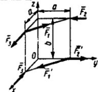
**5.2.11.** Diskning gardishiga  $(\bar{F}_1, \bar{F}_1')$  va  $(\bar{F}_2, \bar{F}_2')$  juft kuchlar ta'sir etadi. Ularning yo'nalishlari  $\bar{F}_1 \parallel Oz$ ,  $\bar{F}_2 \parallel Ox$  va qiymatlari o'zaro teng bo'lsa, teng ta'sir etuvchi juft kuchning momenti vektori  $Ox$  o'qi bilan qanday burchak tashkil etadi? (45)
