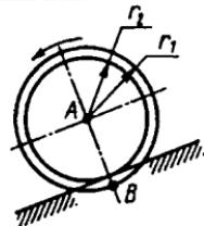
**9.6.3.** Tekislik bo'ylab sirpanmasdan dumalayotgan pog'onali g'ildirakning radiuslari  $r_1=0,6\text{m}$  va  $r_2=0,5\text{m}$  bo'lib,  $A$  nuqtasining tezligi  $v_A=2\text{m/s}$  bo'lsa,  $B$  nuqtasining tezligini aniqlang. (0,4)
