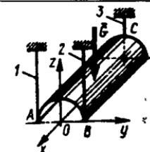
**5.5.15.** O'lchamlari  $OA=1,5$   $AB$  va og'irligi  $G=1$  kN bo'lgan to'rtburchak shaklidagi 4 platforma 1, 2, 3 uchta vertikal sterjenlar yordamida gorizontal holatda ushlab turiladi. Agar uning  $D$  nuqtasiga 5 prujina  $Q=0,5$  kN kuch bilan bossa, 2 sterjenning reaksiya kuchini kN da aniqlang. (0,5)
