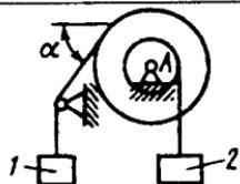
**2.4.25.** Ikkita yuk 1 va 2 iplar yordamida barabanga o'ralgan holda muvozanatda turibdi. Agar 1 yukning og'irligi  $20\text{kN}$  va  $R=2r$ ,  $\alpha=30^\circ$  bo'lsa,  $A$  tayanch reaksiyasining vertikal tashkil etuvchisini kN da toping. (50,0)
