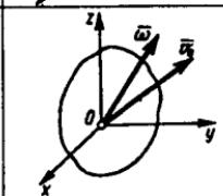
**12.4.6.** Jism bir vaqtning o'zida ikkita aylanma harakatda ishtirok etadi. 1 va 2 parallel o'qlar atrofidagi aylanma harakat burchak tezligi  $\omega_1=1 \text{ rad/s}$  va  $\omega_2=3 \text{ rad/s}$  bo'lsa, jism  $O$  nuqtasining absolut tezligi modulini aniqlang. (3,74)
