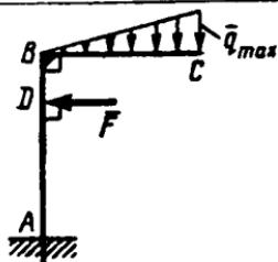
**2.4.48.** Yerga qistirib mahkamlangan  $AB$  to'singa intensivligi  $q=30\text{N/m}$  bo'lgan taqsimlangan kuchlar ta'sir etadi. Agar  $AC=2\text{m}$  va  $A$  tayanchning reaksiya momenti  $M_A=180\text{N}\cdot\text{m}$  bo'lsa,  $BC$  uzunlikning qiymatini toping. (2,0)
