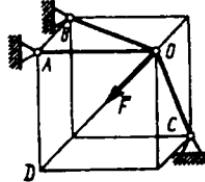
1.4.9. Uchta  $AO$ ,  $BO$  va  $CO$  sterjen sharnir vositasida bog'langan bo'lib,  $O$  sharniriga  $F=18N$  kuch ta'sir etadi. Agar burchaklar  $\alpha=30^\circ$  va  $\beta=45^\circ$  bo'lsa,  $AO$  sterjendagi zo'riqishni toping. (-25,5)
