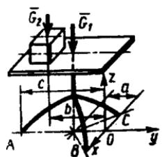
**5.5.7.** Kvadrat shaklidagi bir jinsli, gorizontal  $ABCD$  plitaning og'irligi  $G=500\text{N}$  bo'lib,  $A$ ,  $D$  va  $E$  nuqtalaridan uchta vertikal sterjenlar 1, 2, 3 orqali osilgan. Agar  $AD=2AE$  bo'lsa, 1 sterjening zo'riqishini toping. (500)
