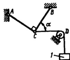
**1.2.14.** Og'irligi  $6\text{N}$  bo'lgan yuk shiftga mahkamlangan teng uzunlikdagi  $AC$  va  $BC$  sterjenlarga rasmida ko'rsatilganidek  $C$  sharnir orqali osib qo'yilgan. Agar  $\alpha=60^\circ$  va  $BC$  sterjendagi zo'riqish  $6,94\text{N}$  bo'lsa,  $AC$  sterjenning zo'riqishini hisoblang. (-3,45)
