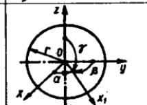
**14.4.23.** Mexanik sistema massalari  $m_1=0,4\text{kg}$  va  $m_2=2\text{kg}$  bo'lgan bir jinsli 1 sterjen va bir jinsli 2 yupqa diskdan iborat. Agar sterjenning uzunligi  $\ell=0,3\text{m}$ , diskning radiusi  $r=0,1\text{m}$  bo'lsa, sistemaning  $Oy$  o'qqa nisbatan inersiya momentini aniqlang. (0,195)
