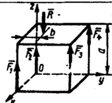
**5.5.4.** Qirrasi  $a=0,4m$  bo'lgan parallelepipedning tomonlariga  $Oy$  o'qiga parallel bo'lgan o'zaro muvozanatlashuvchi kuchlar sistemasi  $F_1=F_2=F_3=F_4=10N$  va  $F_5=40N$  ta'sir etadi.  $F_5$  kuchning qo'yilish nuqtasidan bo'lgan masofa,  $b$  ni aniqlang. (0,3)
