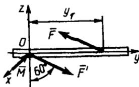
**5.2.15.** Uzunligi  $\ell=0,125\text{m}$  bo'lgan valga momentlari  $M_1=260\text{N}\cdot\text{m}$  va  $M_2=325\text{N}\cdot\text{m}$  li juft kuchlar ta'sir qiladi. Agar  $\bar{M}_1$  va  $\bar{M}_2$  vektorlar  $Oyz$  tekisligida joylashgan bo'lsa,  $O$  podshipnikda hosil bo'layotgan reaksiya kuchining modulini toping. (520)
