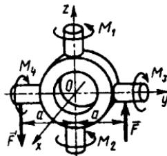
**5.2.13.** Radiusi  $r=1\text{ m}$  bo'lgan diskka momentlari  $M_1=24\text{ N}\cdot\text{m}$  va  $M_2=12\text{ N}\cdot\text{m}$  juft kuchlar ta'sir etib,  $(\bar{F}, \bar{F}')$  juft kuch bilan muvozanatlashadi. Agar  $\bar{M}_1$  va  $\bar{M}_2$  vektorlar  $Ox$  o'qiga parallel va  $(\bar{F}, \bar{F}')$  juft kuch  $Oyz$  tekisligida joylashgan bo'lsa,  $F$  kuchining miqdorini aniqlang. (6)
