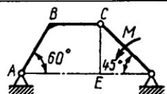
**3.2.13.** O'lchamlari  $AB=BD=1\text{m}$ ,  $CE=DE$  bo'lgan sterjenlarga  $F$  kuchi va momenti  $M=6\text{ kN}\cdot\text{m}$  li just kuch ta'sir etadi.  $A$  sharnirdagi reaksiya kuchining vertikal tashkil etuvchisi  $9\text{ kN}$  bo'lishi uchun  $F$  kuchning qiymati kN da qanchaga teng bo'ladi? (4)
