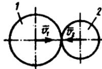
**22.2.10.** Massalari  $m_1=3\text{kg}$  va  $m_2=1\text{kg}$ , tezliklari  $v_{10}=5\text{m/s}$  va  $v_{20}=0$  bo'lgan jismlar to'g'ri markaziy zarbadan keyin bir xil  $v_1=v_2=3,75\text{m/s}$  tezlikka erishsa, kinetik energiyaning sarfini hisoblang. (9,38)
