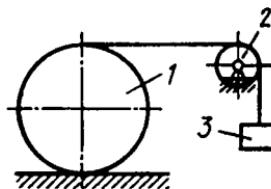
**2.6.16.** Radiuslari  $r=0,5\text{m}$  va  $R=1\text{m}$  bo'lgan g'altakka  $F=20\text{ N}$  li kuch ta'sir qilib, gorizontal tekislikda bir tekisda dumalaydi. Agar dumalab ishqalanish koeffitsiyenti  $\delta=0,01\text{m}$  bolsa, g'altakning og'irligini (kN) da aniqlang. (3,0)
