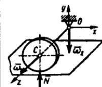
**16.3.16.** Inersiya momenti  $J_z=1,5 \text{kg}\cdot\text{m}^2$ , podshipniklar orasi  $a=0,8 \text{m}$  bo'lgan qayiqning motori o'z o'qi atrofida  $\omega_1=250 \text{rad/s}$ , suv to'lqini natijasida  $\omega_2=0,1 \text{sint}$  burchak tezliklar bilan aylansa, podshipniklarga tushadigan giroskopik reaksiyaning eng katta qiymatini aniqlang. (46,9)
