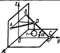
1.4.5. Uchta  $AD$ ,  $BD$  va  $CD$  sterjenlar  $D$  nuqtada sharnir vositasida bog'langan bo'lib, shu nuqtaga  $Oyz$  tekisligida joylashgan  $F=8N$  kuch ta'sir etadi. Agar  $\alpha=20^\circ$  bo'lsa,  $CD$  sterjening zo'riqishini toping. (0)
