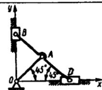
**6.3.5.** Uzunliklari  $OD=0,5\text{m}$  va  $a=0,2\text{m}$  bo'lgan kulisali mexanizmning richagi  $OD$ , sterjeni  $AB$  va polzuni  $B$ , og'irliklari mos ravishda 12, 10 va 6N ga teng. Shaklda ko'rsatilgan holat uchun mexanizmning statik momentini aniqlang. (4,7)
