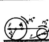
**19.3.9.** Radiuslari bir xil  $r=0,1\text{m}$  bo'lgan ikki g'ildirak vaznsiz 3 sterjen bilan bog'langan bo'lib, og'irlik kuchlari ta'sirida harakatga keladi. Agar  $\alpha=45^\circ$  holatida g'ildiraklarga inersiya kuchlarining bosh vektorlari  $\Phi_1=\Phi_2=10\text{N}$  va bosh momentlari  $M_1^{\phi}=M_2^{\phi}=0,5\text{N}\cdot\text{m}$  ta'sir etsa, 1 g'ildirakning  $G_1$  og'irlik kuchini aniqlang. (30)
