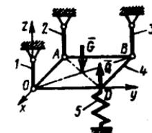
**5.5.16.** Radiuslari  $r=0,1$  m va  $R=0,14$  m, og'irligi  $G=6$  kN bo'lgan val 1,2 va 3 vertikal po'lat arqonlar yordamida gorizontal holatda ushlab turiladi. Agar 2 va 3 arqonlardagi taranglik kuchlari  $T_2=T_3=1,75$  kN bo'lsa, 1 arqonning taranglik kuchini hisoblang. ( $2,5 \cdot 10^3$ )
