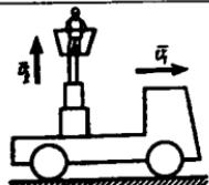
**12.1.4.** Chorpojali kran  $v_3=0,2 \text{ m/s}$  tezlik bilan harakat qiladi. Uning ustida esa aravacha  $v_2=0,3 \text{ m/s}$  tezlik bilan yurib, 1 yukni  $v_1=0,4 \text{ m/s}$  tezlikda yuqoriga tortadi. Yukning absolut tezligini toping. (0,539)
