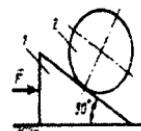
17.3.37. Massasi  $m=10\text{kg}$  bo'lgan silindr qo'zg'almas prizma ustida og'irlik kuchi va juft kuch momenti  $M$  ta'sirida dumalaydi. Agar silindr massa markazining tezlanishi  $a=6\text{m/s}^2$  bo'lsa, tekislikning prizmaga ko'rsatgan bosimining gorizonttal tashkil etuvchisini toping. (52,0)
