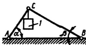
**1.2.8.** Og'irligi  $14\text{N}$  bo'lgan yuk devorga mahkamlangan.  $AC$  va  $BC$  sterjenlar hamda  $D$  barabanga o'ralgan zanjir  $C$  blok yordamida osib qo'yilgan. Agar zanjir sterjen bilan  $\alpha=30^\circ$  burchaklar hosil qilsa,  $AC$  sterjenning zo'riqishini aniqlang. (-24,2)
