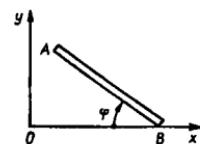
**9.4.3.**  $AB$  sterjennining  $A$  nuqtasi radiusi  $R=1\text{m}$  bo'lган aylana bo'ylab  $s_A=1,05t$  qonun bo'yicha harakat qiladi. Bir vaqtning o'zida sterjen  $\varphi=t$  qonun bilan aylanadi. Agar sterjennining uzunligi  $AB=1\text{m}$  bo'lsa,  $t_1=1\text{s}$  paytda uning  $B$  nuqtasi tezligining  $Oy$  o'qiga proyeksiyasini aniqlang. (-0,319)
