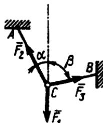
**1.2.3.**  $AB$  to‘sini  $AC$  va  $BC$  arqonlar yordamida shiftga osib qo‘yilgan. Agar arqonlar vertikalga  $\alpha=45^\circ$  va  $\beta=30^\circ$  burchak ostida, arqonlardagi zo‘riqishlar  $F_1=120\text{N}$   $F_2=80\text{N}$  bo‘lsa, to‘sining og‘irligini aniqlang. (154)
