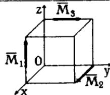
**5.2.3.** Parallelepipedga momentlari  $M_1=M_2=M_3=M_4=100$  N·m bo'lgan to'rtta juft kuch ta'sir qilsa, ularning teng ta'sir etuvchisi momentining miqdorini toping. (200)
