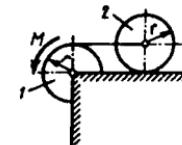
**20.5.16.** Radiuslari  $r_1=r_3=10\text{sm}$  va  $r_2=r_4=15\text{sm}$  bo'lgan g'ildiraklar momenlari  $M_1=5\text{N}\cdot\text{m}$  va  $M_2=9\text{N}\cdot\text{m}$  li juft kuchlari ta'sirida harakatga kelib,  $T=2\dot{\phi}_1^2$  kinetik energiyaga ega bo'lsa, 1 g'ildirakning burchak tezlanishi  $\dot{\phi}$  ni aniqlang. (0,25)
