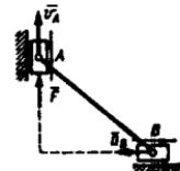
**14.1.15.** Uzunligi  $OA=0,25\text{m}$  bo'lgan krivoship  $1$   $\omega=10\text{rad/s}$  o'zgarmas burchak tezlik bilan aylanib, massasi  $m=5\text{kg}$  bo'lgan kulisan 2 harakatga keltiradi.  $\varphi=60^\circ$  bo'lgan paytdagi kulisaga ta'sir qiluvchi tashqi kuchlar bosh vektorining modulini hisoblang. (62,6)
