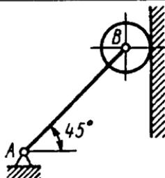
**3.2.28.** Konstruksiya 1 sterjen, 2 yuk va boshqa qismlardan iborat bo'lib, uning 2 qismi 100N ga teng. Boshqa qismlarning vaznlarini hisobga olmay, 1 sterjenda hosil bo'layotgan zo'riqish ku chini hisoblang. (905)
