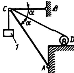
**1.2.9.** Og'irligi  $20\text{N}$  bo'lgan yuk shiftga mahkamlangan  $OA$  va  $OB$  sterjenlarga hamda  $C$  nuqtaga bog'langan arqon yordamida osib qo'yilgan. Agar  $\alpha=40^\circ$  va  $\beta=45^\circ$  bo'lsa,  $OA$  sterjenda hosil bo'lgan reaksiya kuchini toping. (-21,7)
