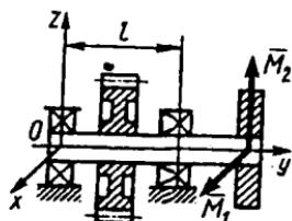
**5.2.17.** Uzunligi  $\ell=0,1\text{m}$  bo'lgan valga momentlari  $M_1=4\text{N}\cdot\text{m}$ ,  $M_2=2\text{N}\cdot\text{m}$ ,  $M_3=5\text{N}\cdot\text{m}$  ga teng juft kuchlar ta'sir etadi. Agar juft kuch momentlari vektori  $\bar{M}_1 \parallel Ox$  va  $\bar{M}_2 \parallel Oz$ ,  $\bar{M}_3 \parallel Oz$  bo'lsa,  $O$  podshipnik reaksiya kuchini hisoblang. (50)
