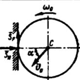
**22.4.6.** Massasi  $m=0,2\text{kg}$  bo'lgan shar aylanma harakatsiz  $v_0=2\text{m/s}$  tezlik bilan  $\alpha=45^\circ$  burchak ostida qo'zg'almas gorizontal tekislikka uriladi va  $\beta=60^\circ$  burchak ostida  $v=1,5\text{m/s}$  tezlik bilan yuqoriga sapchiydi. Urinma impuls  $\bar{S}_F$  ning modulini aniqlang. ( $2,30 \cdot 10^{-2}$ )
