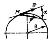
**13.3.6.** Moddiy nuqta egri chiziqli trayektoriya bo'ylab urinma  $F_t=0,2\text{t}^2$  tashkil etuvchi va normal  $F_n=8\text{N}$  tashkil etuvchi kuchlar ta'sirida harakat qiladi.  $t=10\text{s}$  da uning tezlanishi  $a=0,7\text{m/s}^2$  bo'lsa, nuqtaning massasini toping. (30,8)
