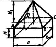
**6.3.10.** O'lchamlari  $r=0,2\text{m}$ ,  $a=0,5\text{m}$ ,  $b=1,5\text{m}$  va  $c=1,8\text{m}$  bo'lgan bir jinsli jismning og'irlik markazi  $y_C$  koordinatasini aniqlang. (0,762)
