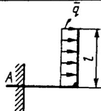
**2.3.24.** Qistirib mahkamlangan ramaning qancha qismiga intensivligi  $q_{\max}=1\text{N/m}$  bo'lgan taqsimlangan kuchlar ta'sir etsa,  $A$  tayanchning reaksiya kuchi  $R_A=2\text{N}$  bo'ladi? (4,0)
