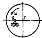
**14.1.8.** Radiusi  $R=1,3\text{m}$  bo'lgan g'ildirakning massa markazi  $C$   $s=4t$  qonun bo'yicha harakat qilsa, uning massasini  $M=15\text{kg}$  deb, ta'sir qiluvchi tashqi kuchlar bosh vektorining modulini toping. (185)
