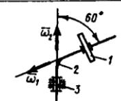
**12.2.10.** Parallelogramm shaklidagi plastinka bir vaqtning o'zida ikkita aylanma harakatda ishtirok etadi. Agar burchak tezliklari  $\omega_1=2\text{rad/s}$  va  $\omega_2=4\text{rad/s}$  bo'lsa, disk absolut burchak tezligi vektori va  $\bar{\omega}_2$  orasidagi burchak necha gradus bo'ladi? (30)
